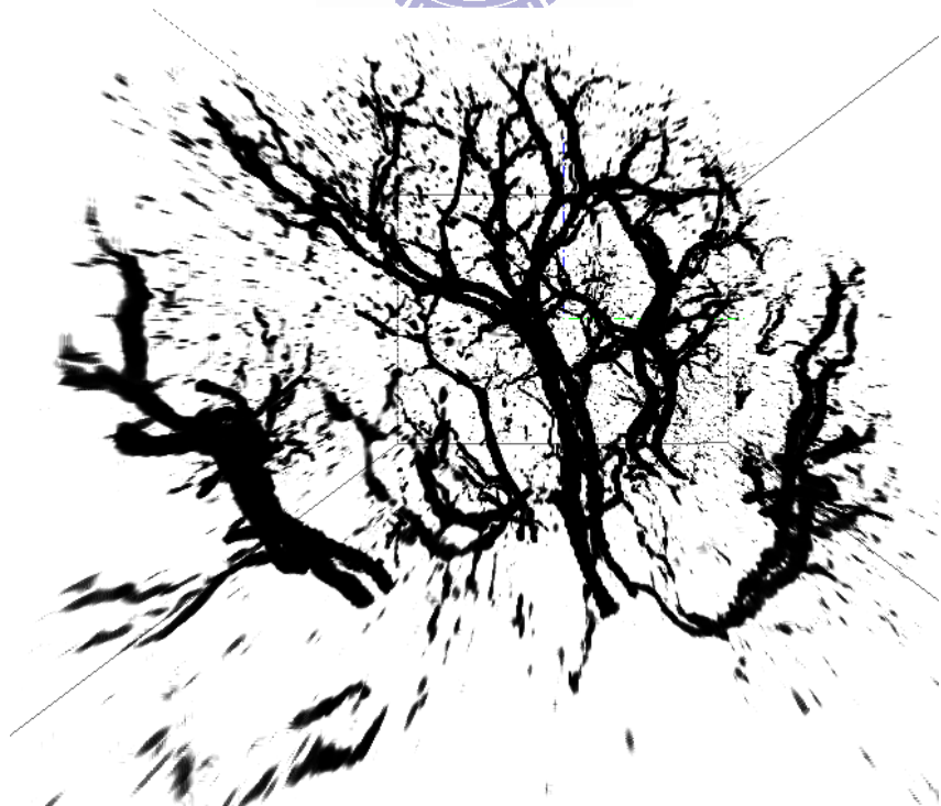
圖 4-3 FBP 重建結果 200 projections, threshold 55, connected component > 10
