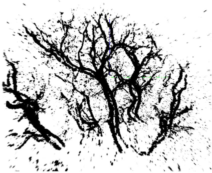
圖 4-4 FBP 重建結果 50 projections, threshold 55, connected component > 10
