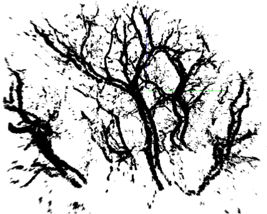
圖 4-5 FBP 重建結果 50 projections, threshold 55, connected component > 50
