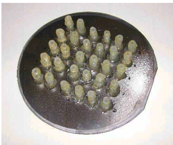
圖 2-6 微流體裝置背面，輸水管與入口區黏合
