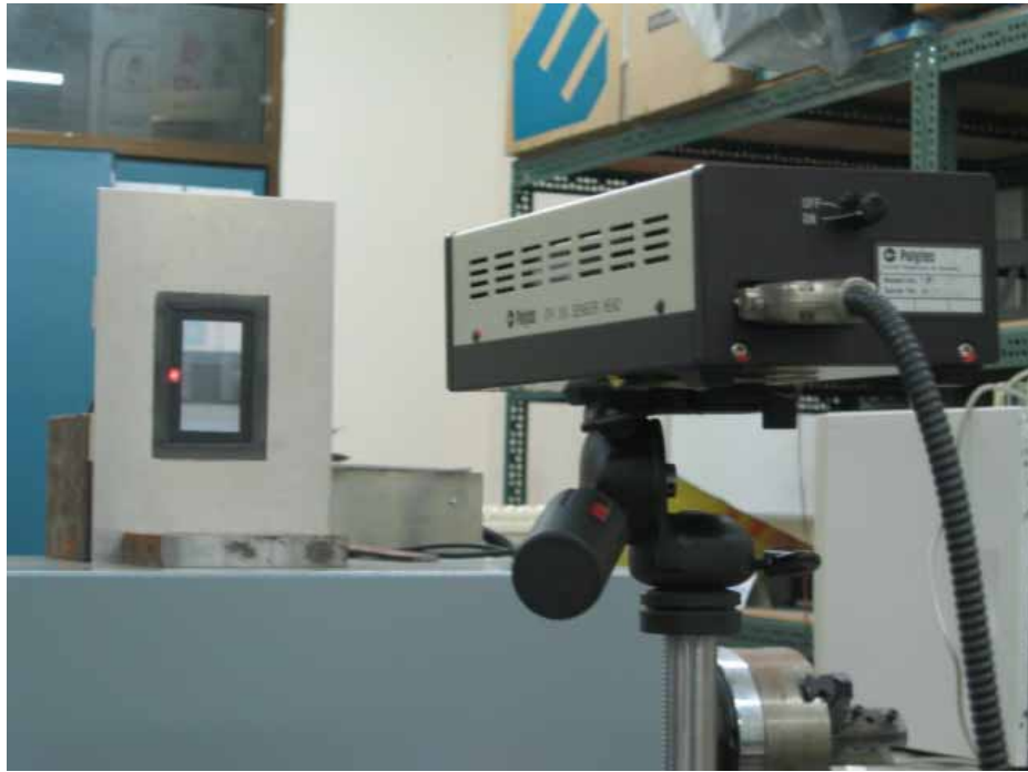
圖 4-13 振動實驗雷射測速儀架設圖
