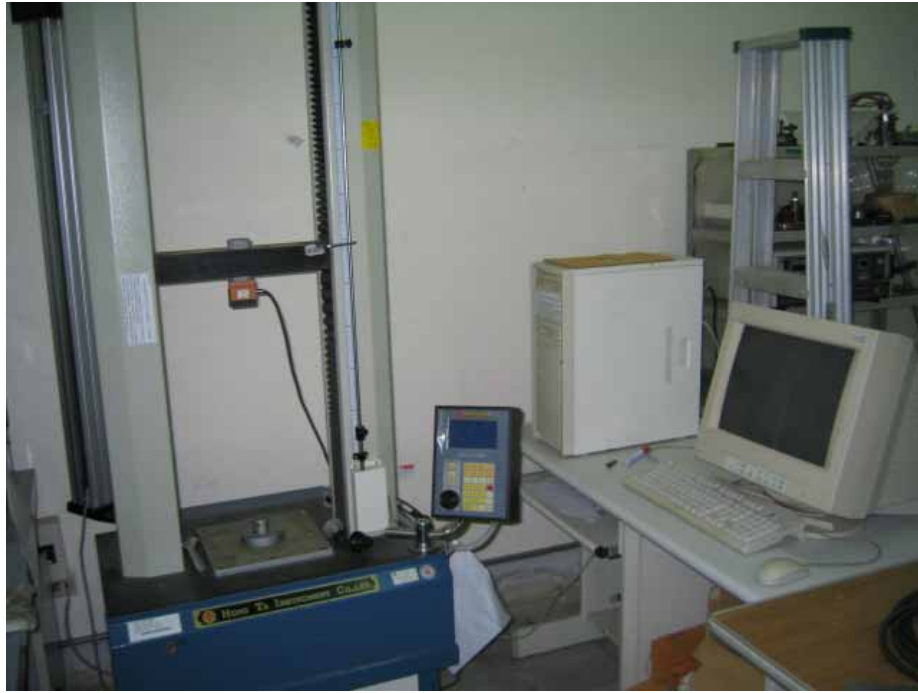
圖 4-7 HT-9102 電腦伺服控制材料試驗機
