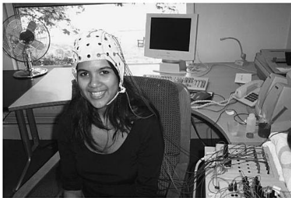
圖 2-3 腦電波儀（EEG）的使用情形 圖為使用者戴上EEG的帽子，帽子上佈滿了偵測用的電極。 資料來源：Blakemore & Frith（2005）
