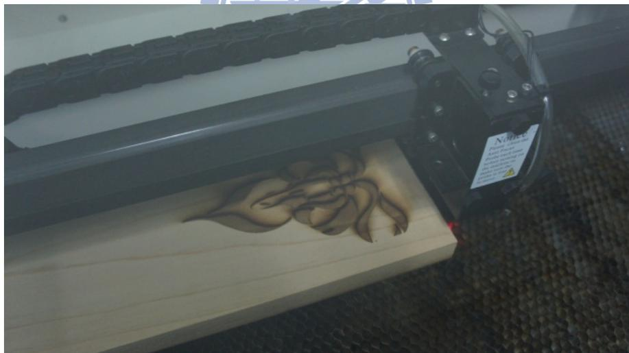
圖 3-39 雷射切割裝飾圖樣
