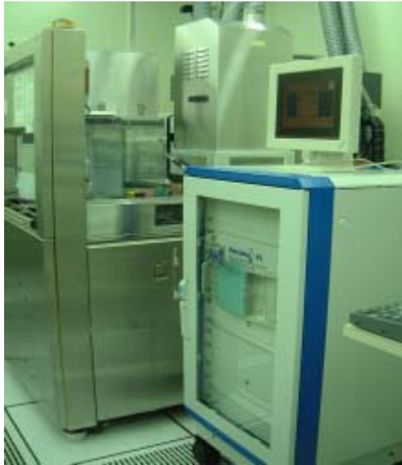
【圖 4-1】實驗設備圖示，左：蝕刻機台、右：感測器
