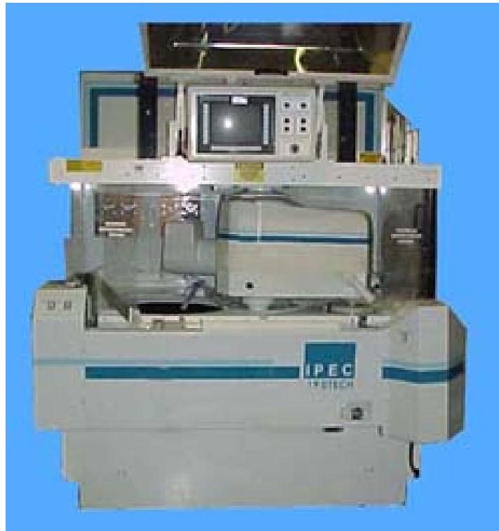
圖 5.2 NDL IPEC/Westech Model 372 Polisher 化學機械研磨機
