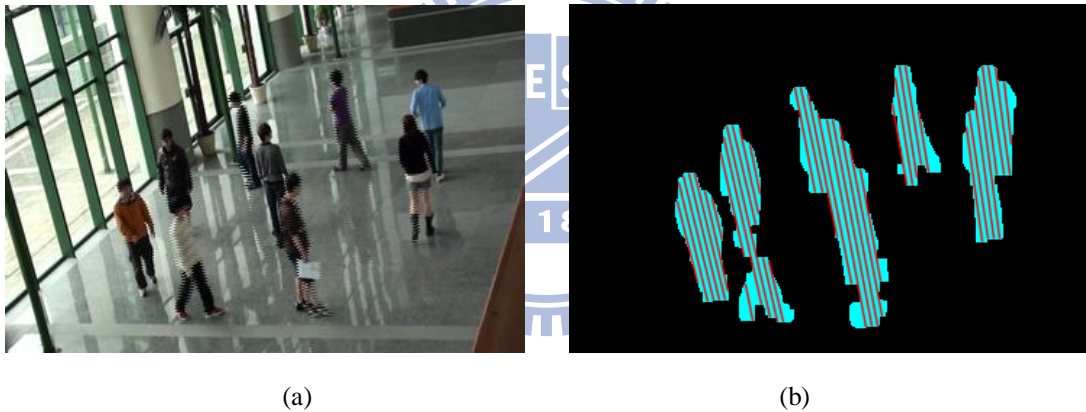
圖 5.1 (a)為第一段影片中攝影機 1 號的畫面，(b)為透過消失點來對前景區域做取樣的樣本線段。
