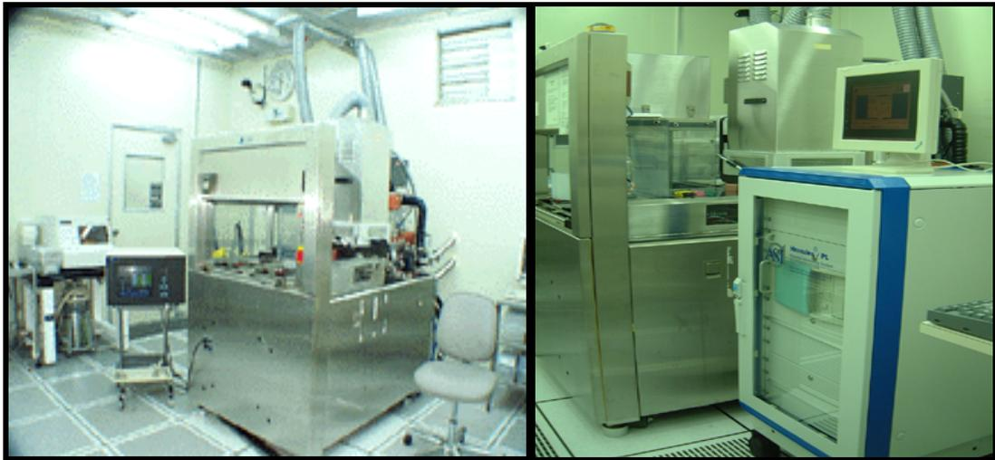
圖 5-14 (a)NDL 之 Lam-TCP9400 機台 (b)ASI Hercules 裝置
