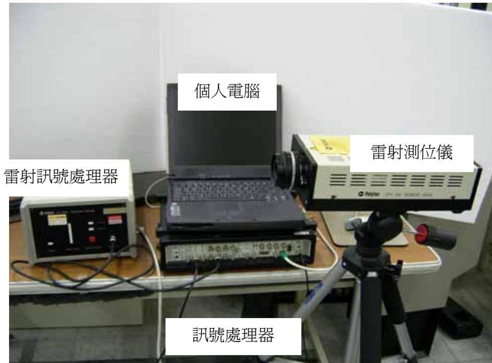
圖 5-3 B&K Pulse 雷射測位儀
