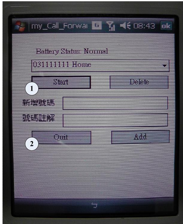
圖 B.5. 按下啟用按鈕開始偵測電池狀態
