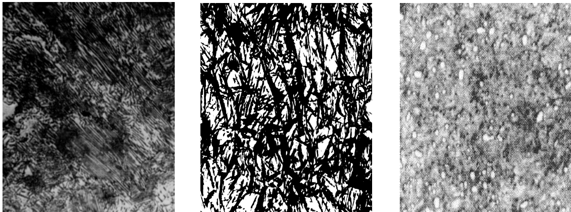
圖 2-7 (a)波來鐵(b)變韌鐵(c)回火麻田散鐵( \times 7500 )
