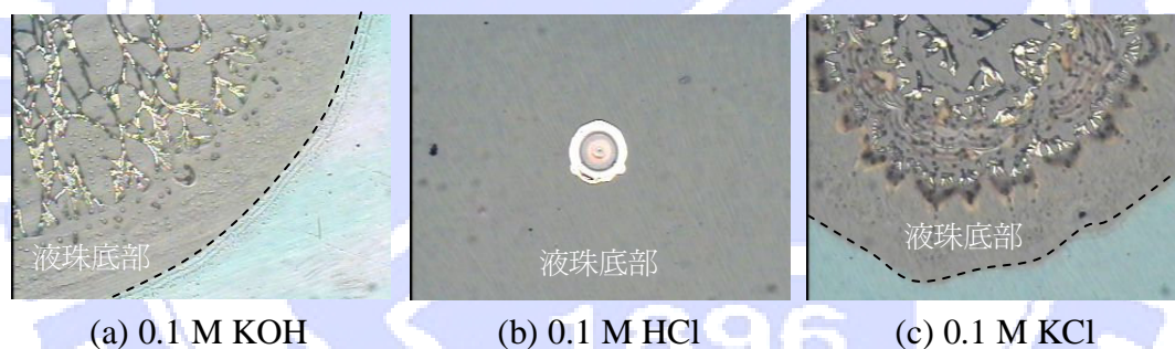
圖 3-20 不同電解質破壞 SU-8 後的照片
