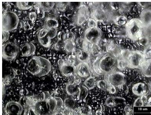
圖 53 PC/iPP(40/60)高頻型試片，成形壓力 500bar : inner phase, cross nicol
