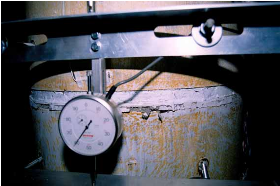
照片 3.35 試體 SP1 第一、二節塊間混凝土剝落 ( \theta = +0.04 弧度)
