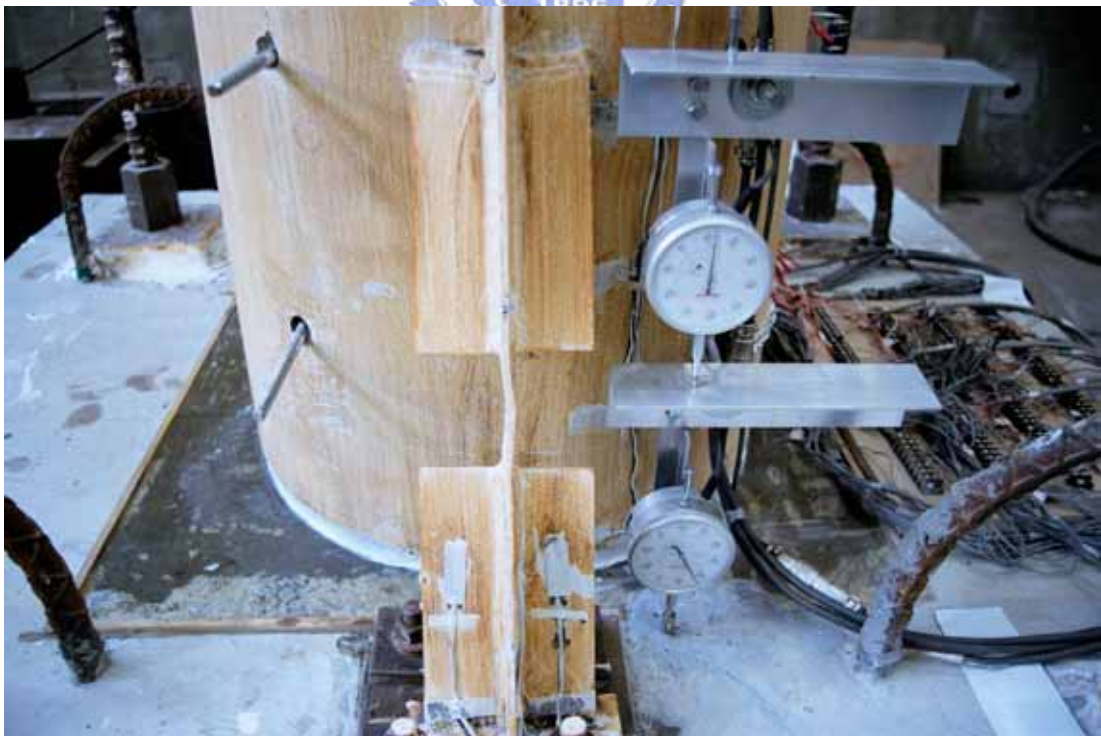
照片 3.46 試體 SP2 消能桿件受壓發生挫屈情況 ( \theta = +0.006 弧度)
