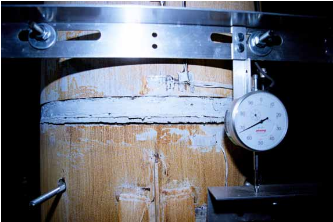
照片 3.49 試體 SP2 第一與第二節塊間撓曲裂縫 ( \theta = +0.015 弧度)
