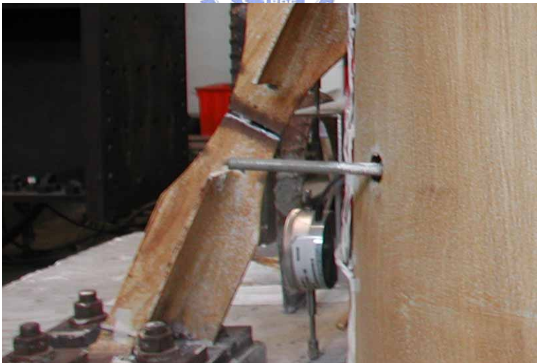
照片 3.60 試體 SP2 消能桿件受拉斷裂情況 ( \theta = +0.04 弧度)
