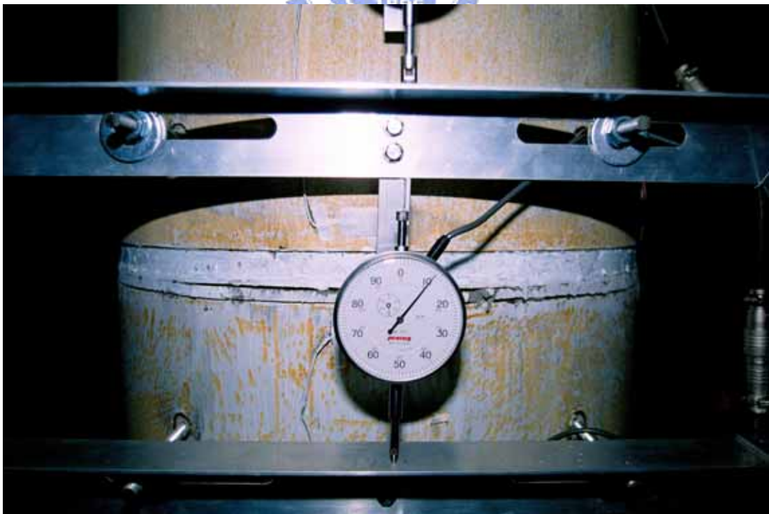
照片 3.34 試體 SP1 第一、二節塊間混凝土裂縫( \theta = +0.04 弧度)
