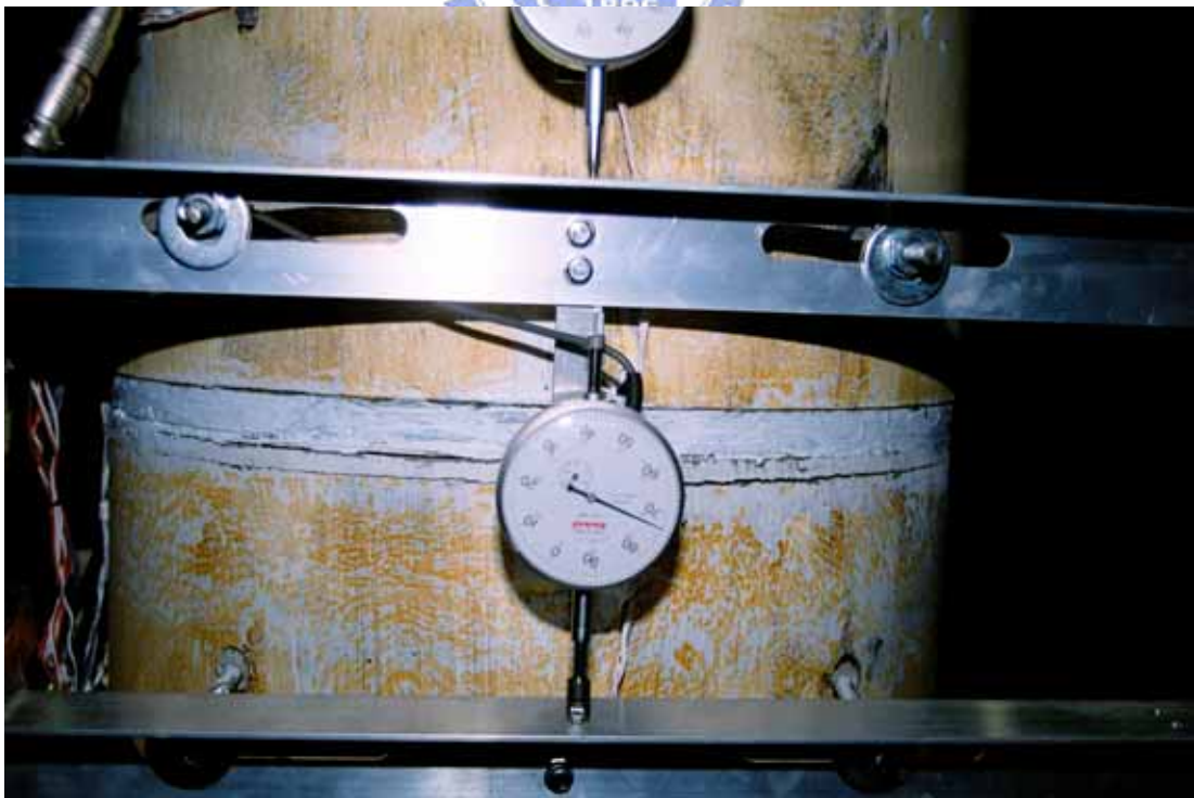
照片 3.24 試體 SP1 第一節塊上方撓曲裂縫 ( \theta = +0.02 弧度)
