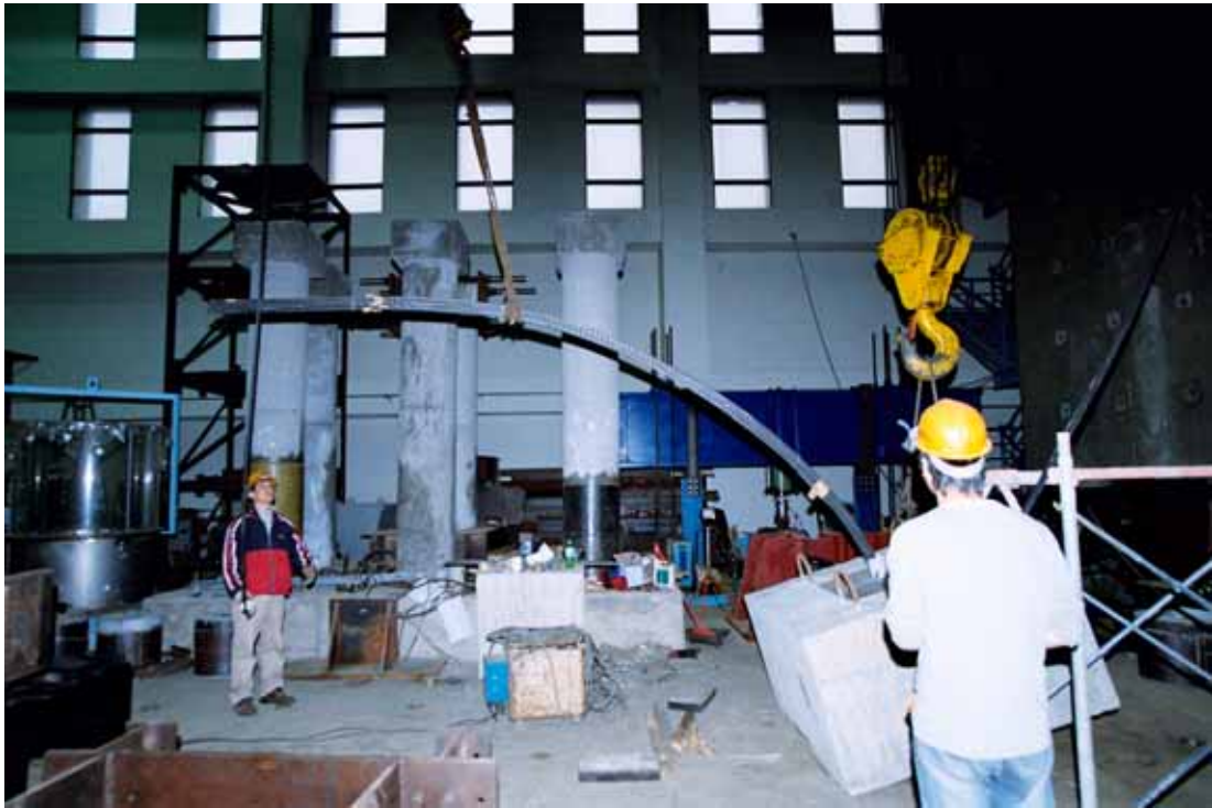
照片 3.9 基礎翻轉固定在強力地板
