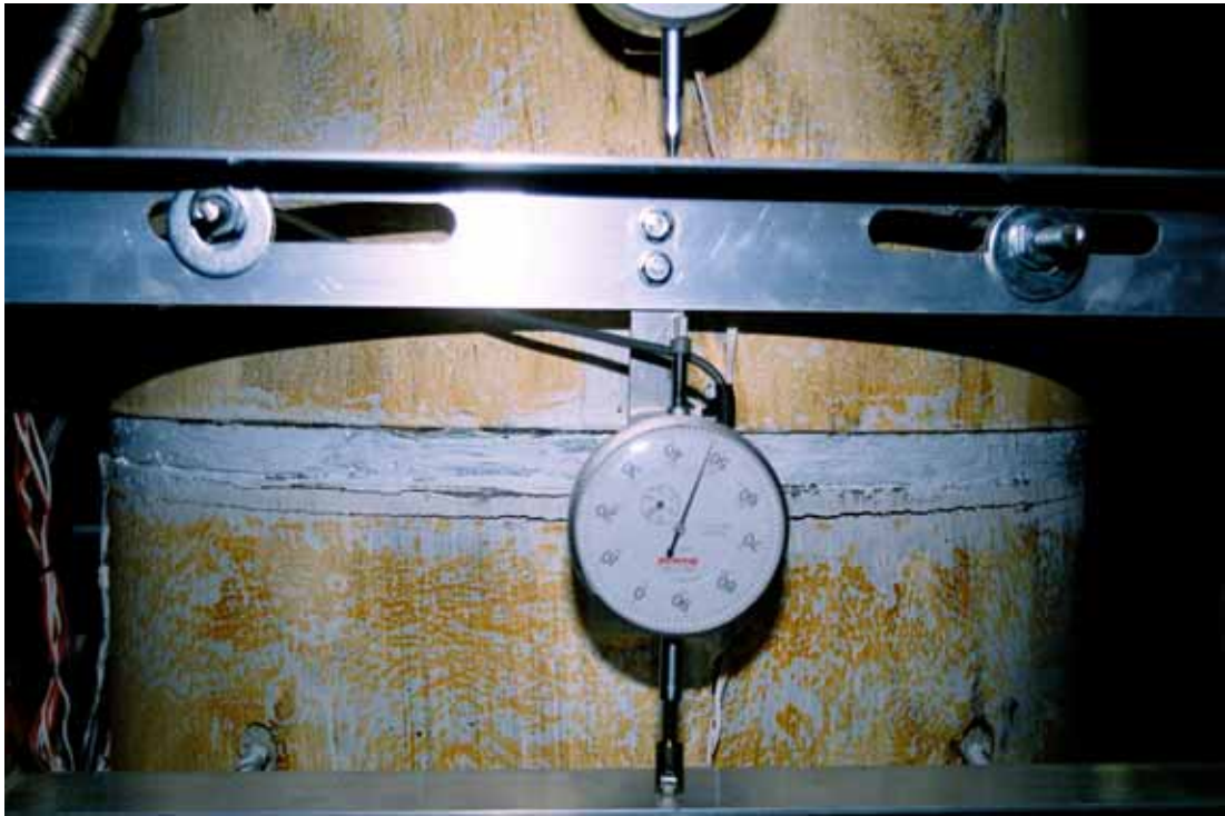
照片 3.21 試體 SP1 第一節塊上方撓曲裂縫 ( \theta = +0.015 弧度)
