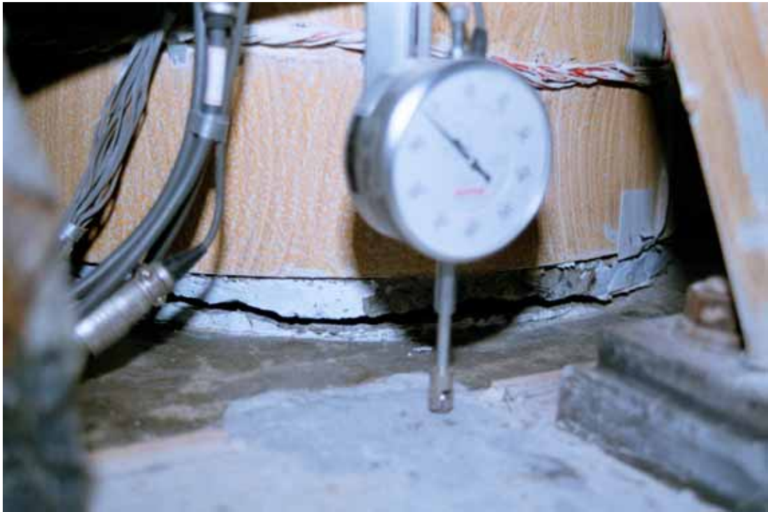
照片 3.61 試體 SP2 第一節塊底部撓曲裂縫 ( \theta = +0.04 弧度)
