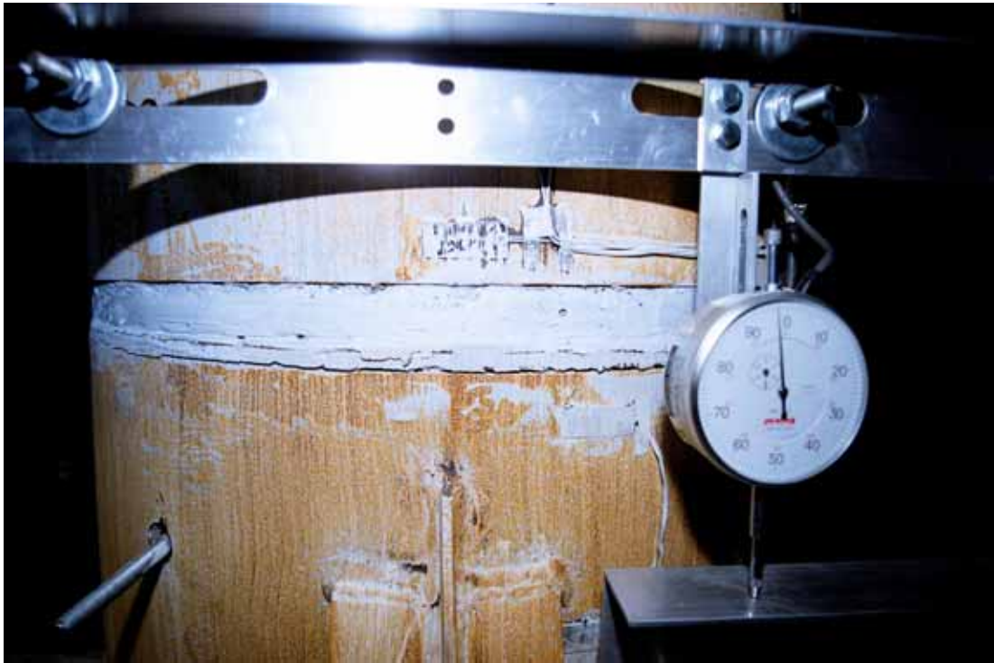
照片 3.47 試體 SP2 第一與第二節塊間裂縫發展情況( \theta = +0.009 弧度)
