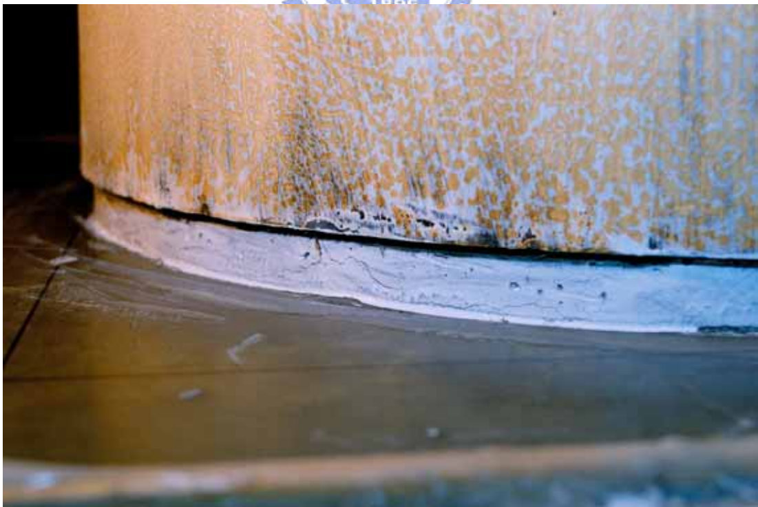
照片 3.18 試體 SP1 柱底部裂縫 ( \theta = +0.006 弧度)
