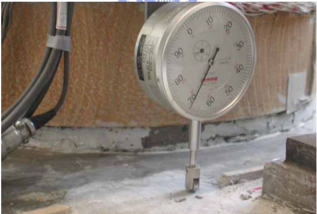
照片 3.54 試體 SP2 第一節塊底部混凝土剝落 ( \theta = +0.03 弧度)
