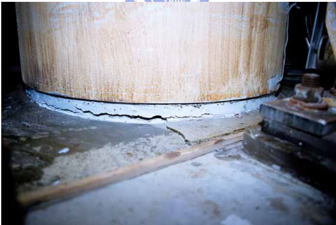
照片 3.52 試體 SP2 第一節塊底部撓曲裂縫 ( \theta = +0.03 弧度)
