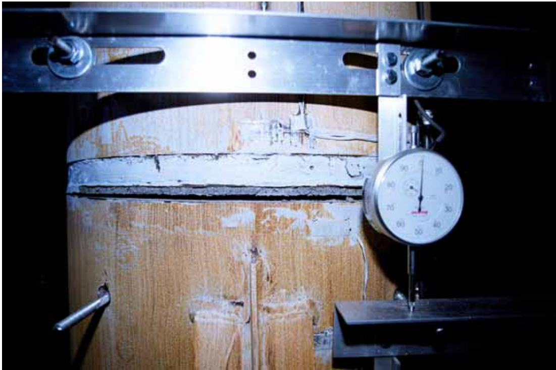
照片 3.55 試體 SP2 第一與第二節塊間撓曲裂縫( \theta = +0.03 弧度)
