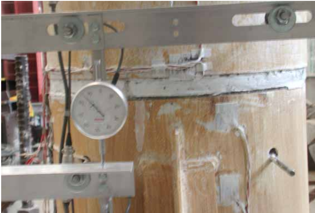
照片 3.57 試體 SP2 第一與第二節塊間混凝土剝落( \theta = +0.03 弧度)
