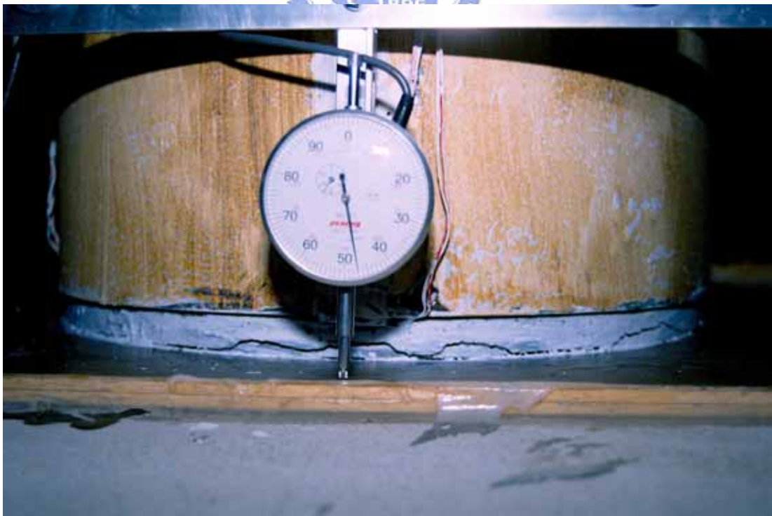
照片 3.20 試體 SP1 柱底部撓曲裂縫 ( \theta = +0.015 弧度)
