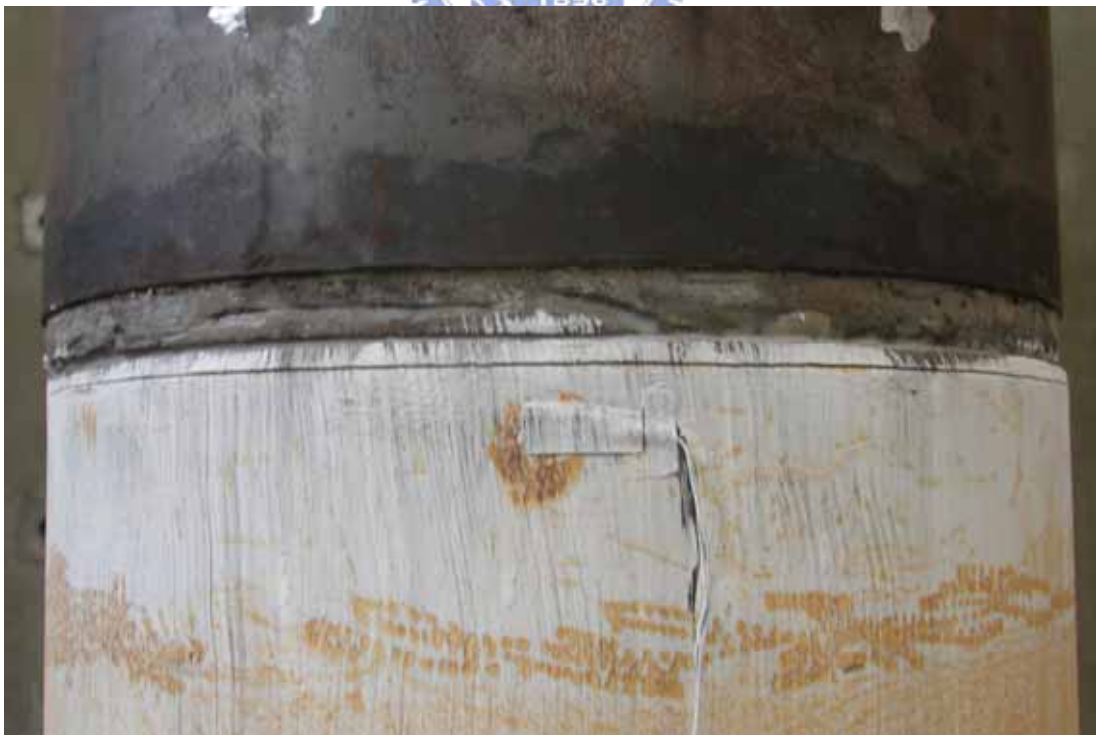
照片 3.58 試體 SP2 第二與第三節塊間撓曲裂縫( \theta = +0.03 弧度)
