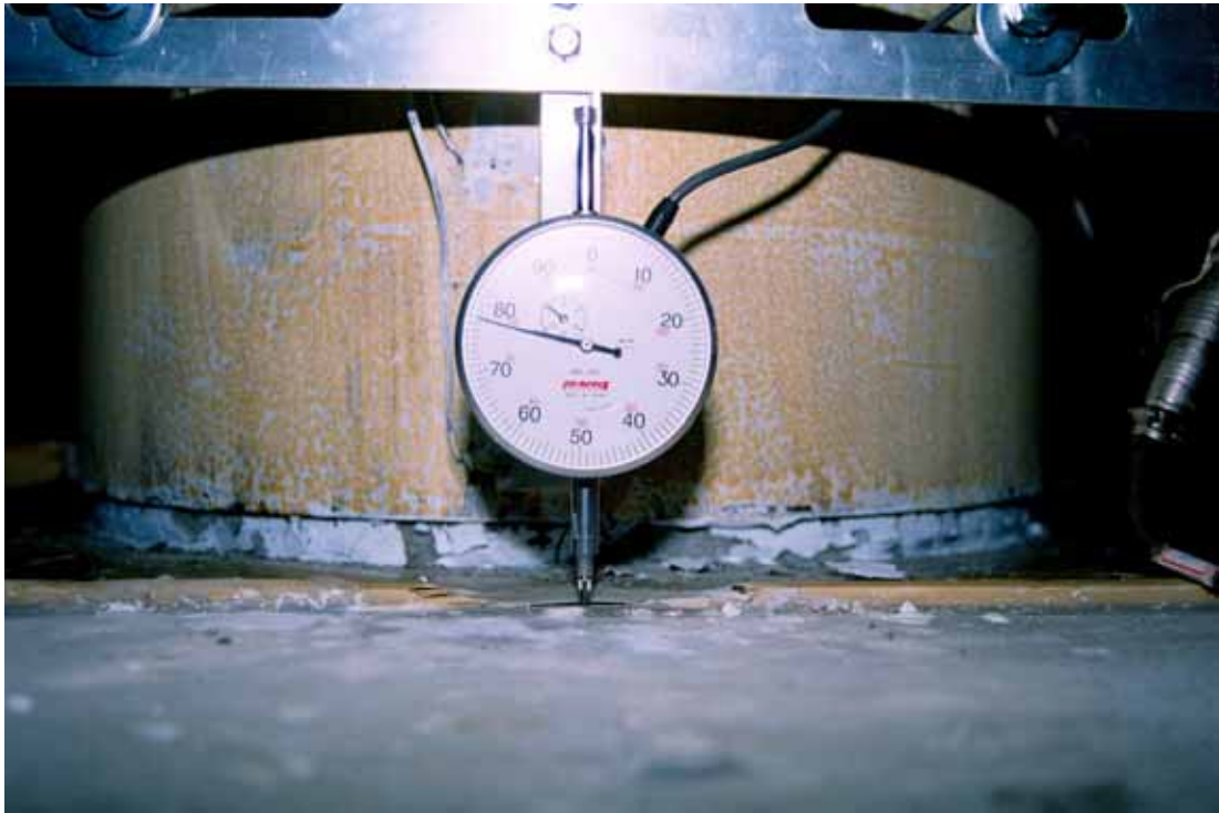
照片 3.33 試體 SP1 柱底部混凝土剝落 ( \theta = +0.04 弧度)
