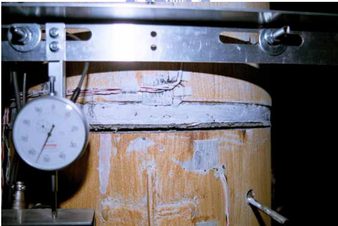
照片 3.62 試體 SP2 第一與第二節塊間撓曲裂縫 ( \theta = +0.04 弧度)
