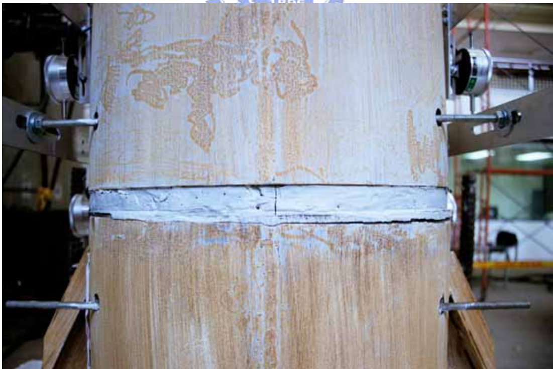
照片 3.56 試體 SP2 第一與第二節塊間裂縫長度 ( \theta = +0.03 弧度)
