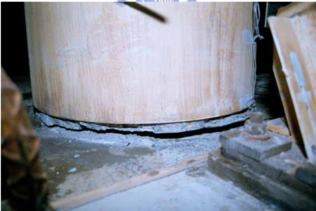
照片 3.66 試體 SP2 第一節塊底部撓曲裂縫 ( \theta = +0.06 弧度)
