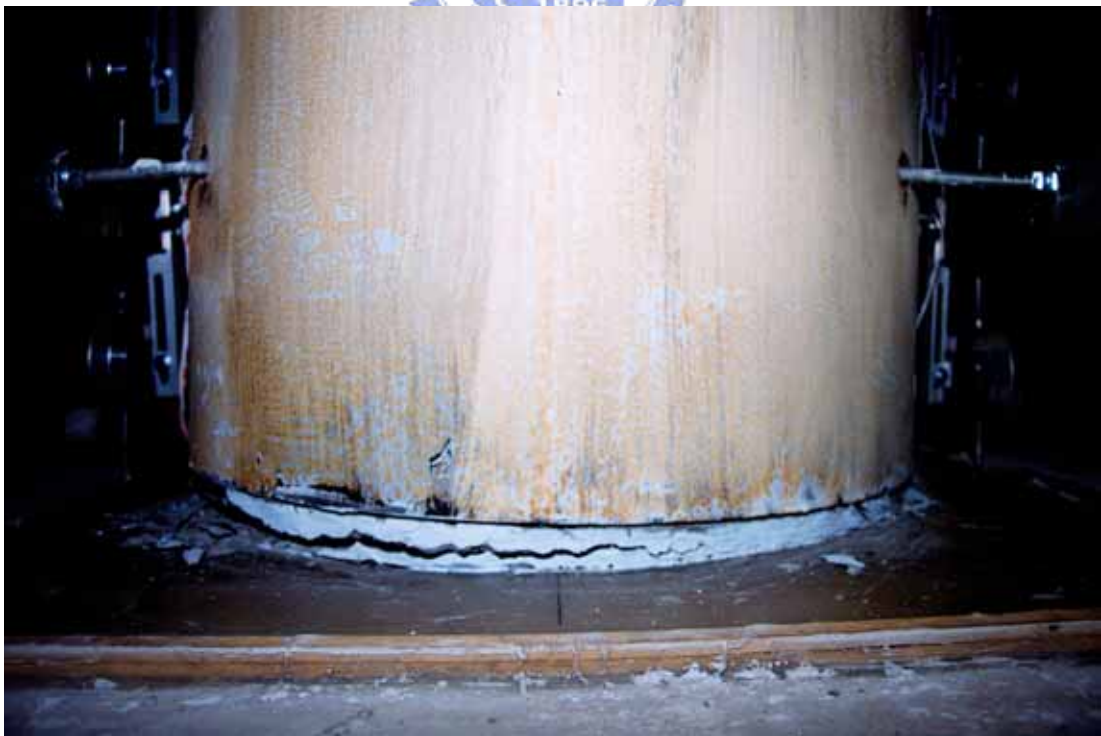
照片 3.36 試體 SP1 柱底撓曲裂縫 ( \theta = +0.05 弧度)
