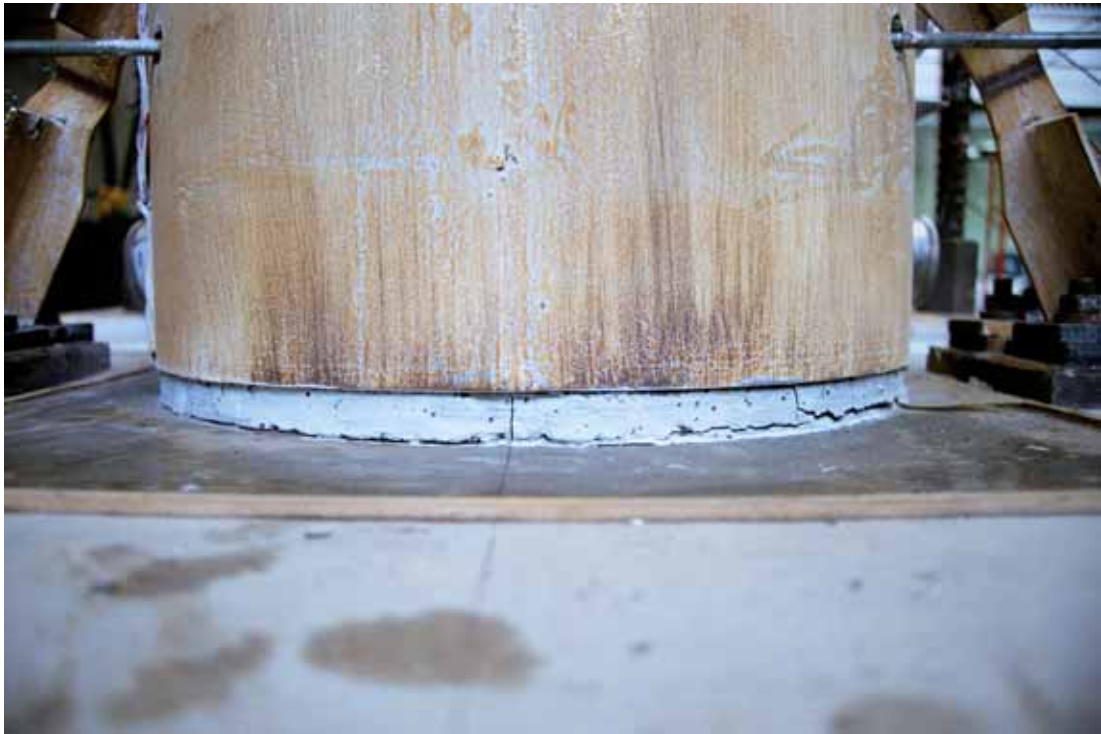
照片 3.53 試體 SP2 第一節塊底部裂縫長度 ( \theta = +0.03 弧度)
