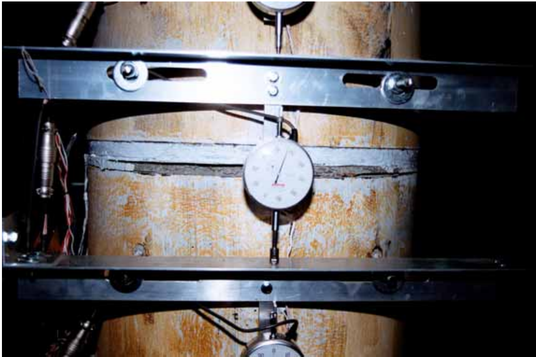
照片 3.41 試體 SP1 第一、二節塊間無收縮水泥剝落 ( \theta = +0.06 弧度)
