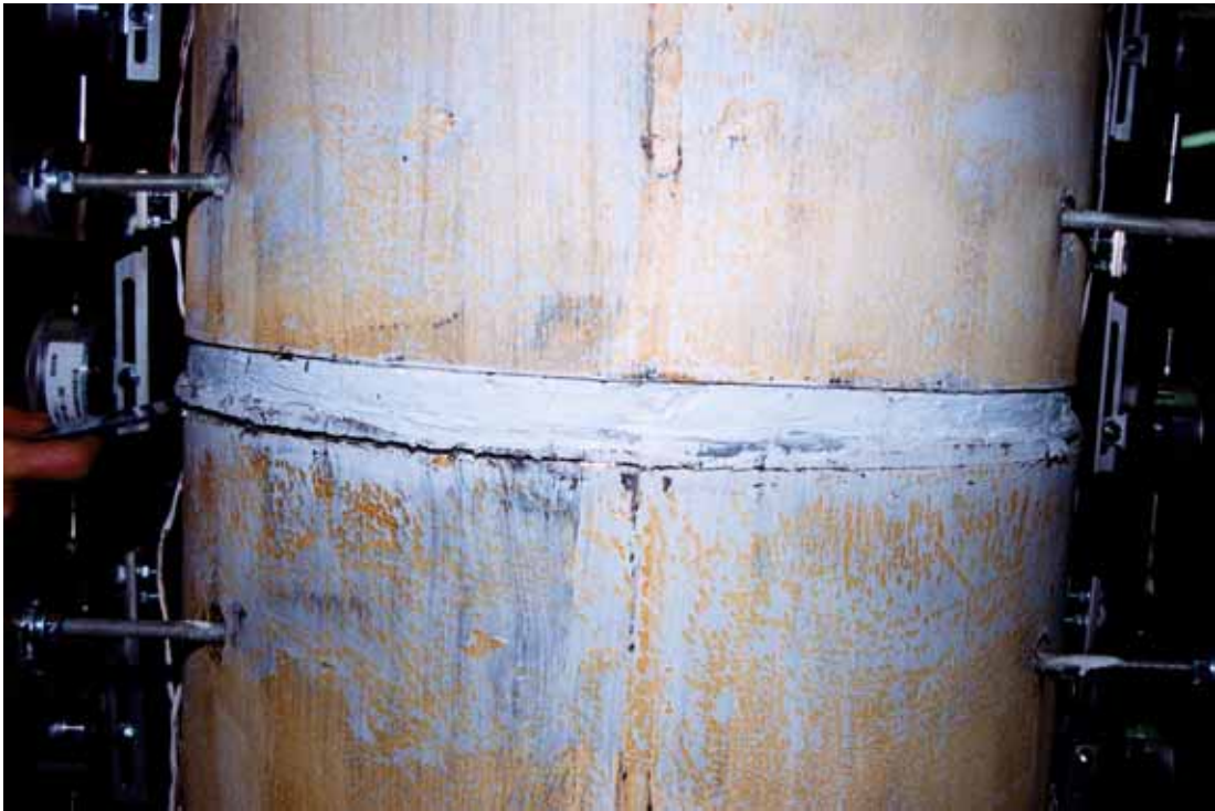
照片 3.37 試體 SP1 第一、二節塊介面間撓曲裂縫 ( \theta = +0.05 弧度)
