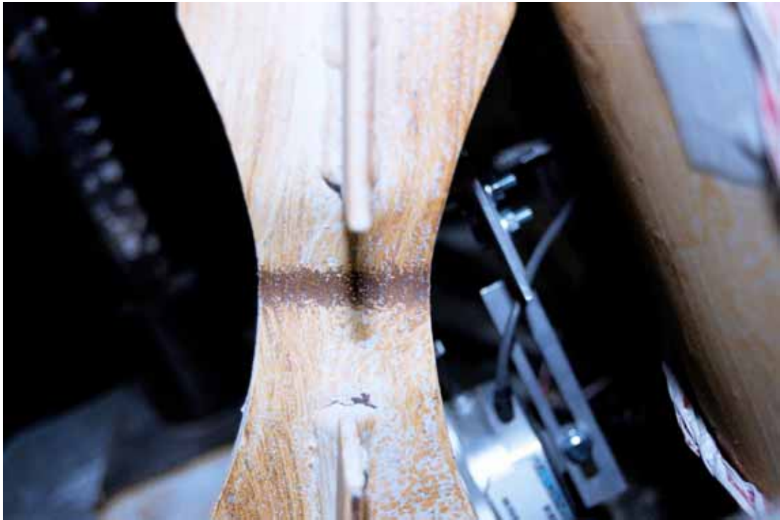
照片 3.51 試體 SP2 消能桿件上發現有明顯的降伏線( \theta = +0.02 弧度)
