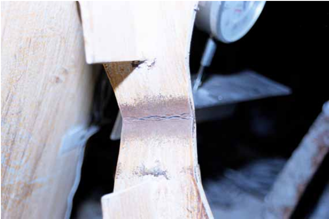
照片 3.59 試體 SP2 消能桿件挫屈情形 ( \theta = +0.03 弧度)
