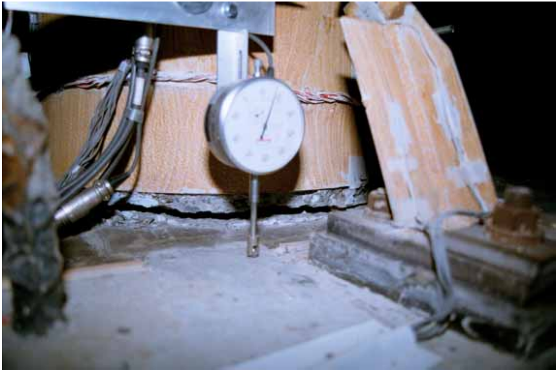
照片 3.63 試體 SP2 第一節塊底部撓曲裂縫( \theta = +0.05 弧度)
