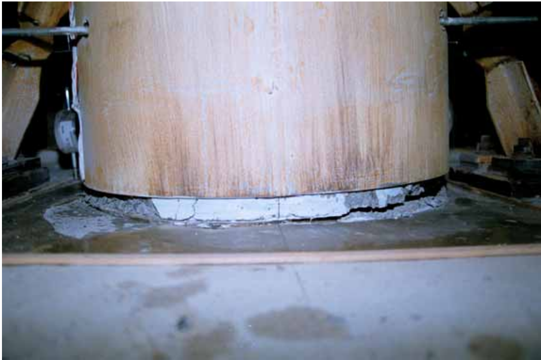
照片 3.67 試體 SP2 第一節塊底部裂縫長度( \theta = +0.06 弧度)
