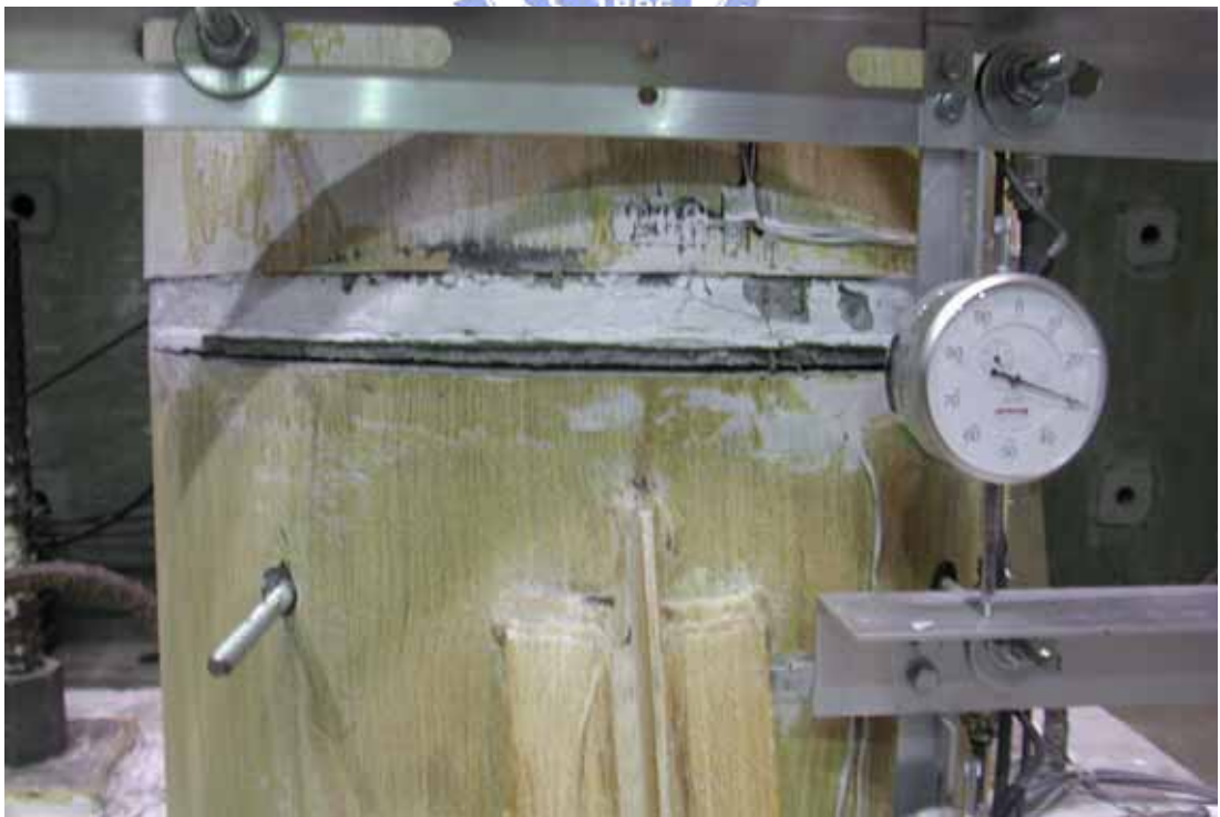
照片 3.68 試體 SP2 第一與第二節塊間撓曲裂縫( \theta = +0.06 弧度)
