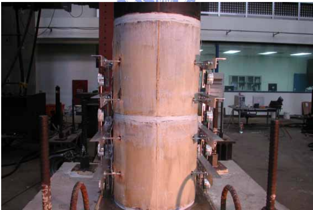
照片 3.44 量測曲率變化的位移計配置圖
