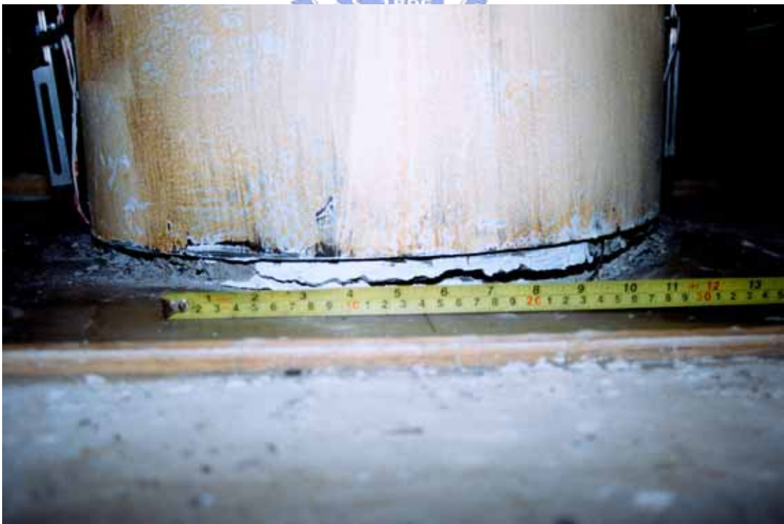
照片 3.40 試體 SP1 柱底部裂縫長度 ( \theta = +0.06 弧度)
