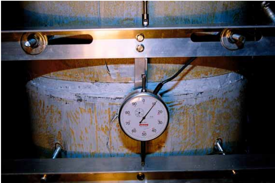
照片 3.19 試體 SP1 第一節塊上方撓曲裂縫 ( \theta = +0.006 弧度)
