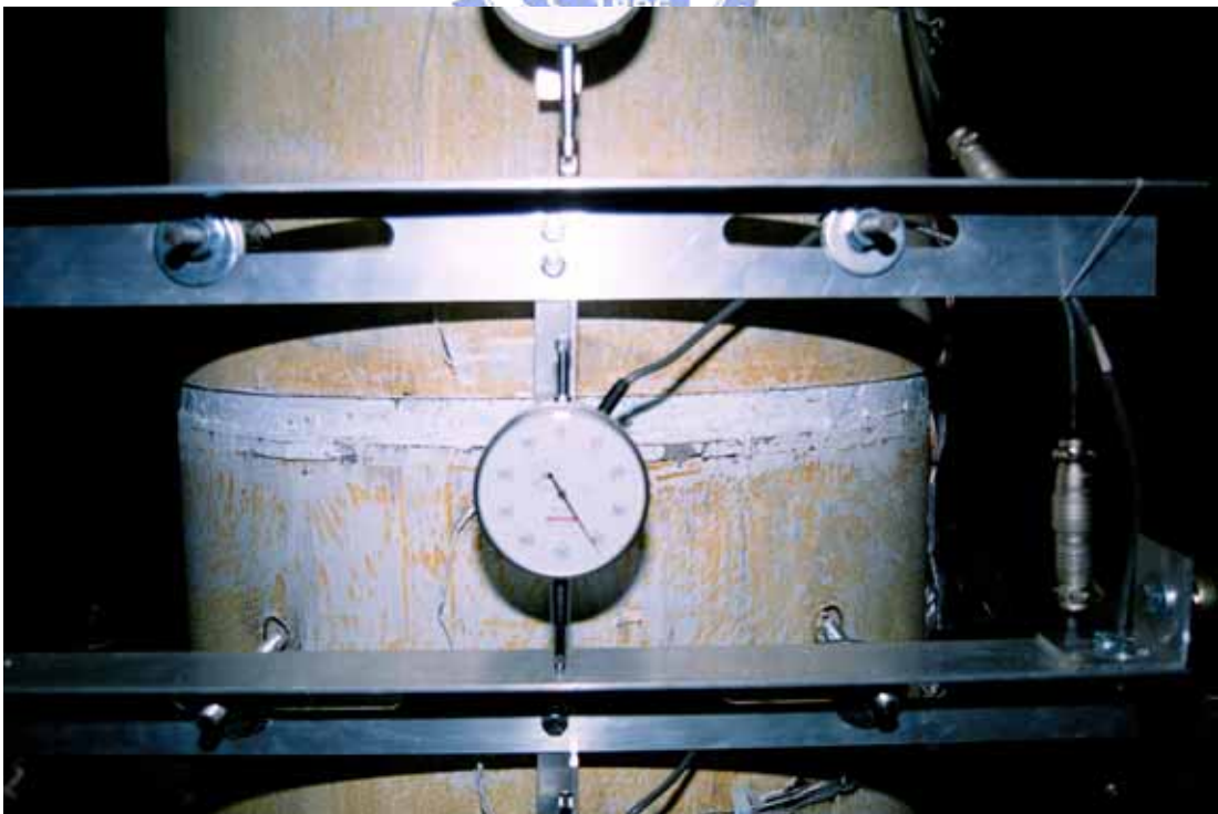
照片 3.30 試體 SP1 第一、二節塊間無收縮水泥剝落( \theta = +0.03 弧度)
