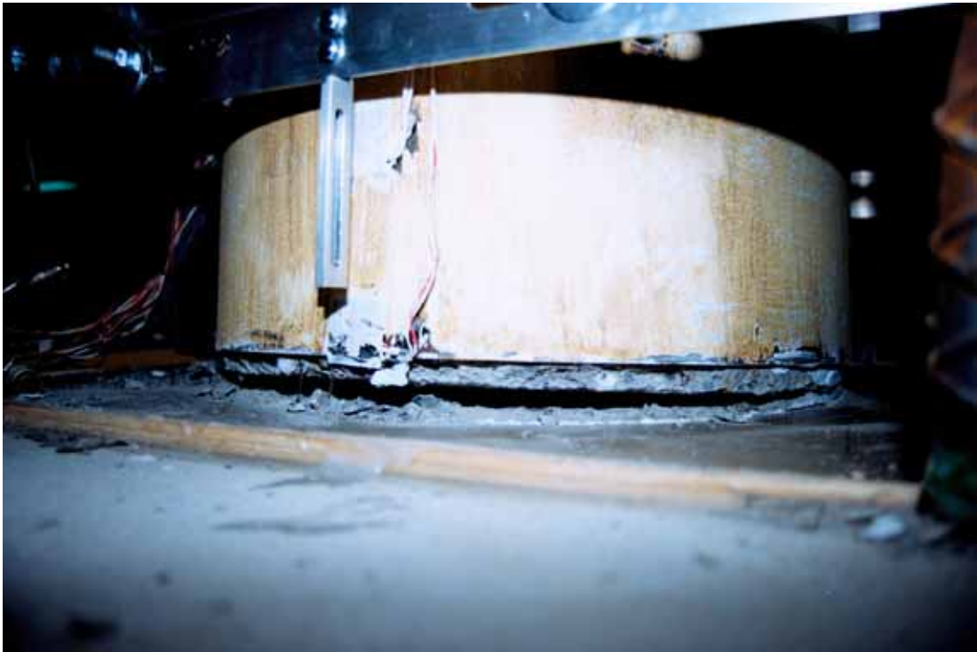
照片 3.39 試體 SP1 柱底部撓曲裂縫( \theta = +0.06 弧度)
