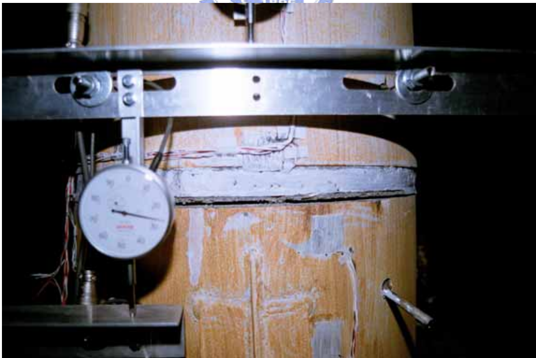
照片 3.64 試體 SP2 第一與第二節塊間撓曲裂縫 ( \theta = +0.05 弧度)
