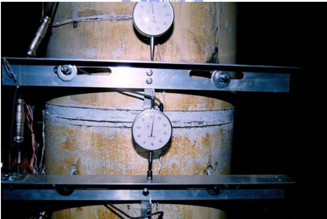
照片 3.28 試體 SP1 第一與第二節塊間混凝土裂縫 ( \theta = +0.03 弧度)
