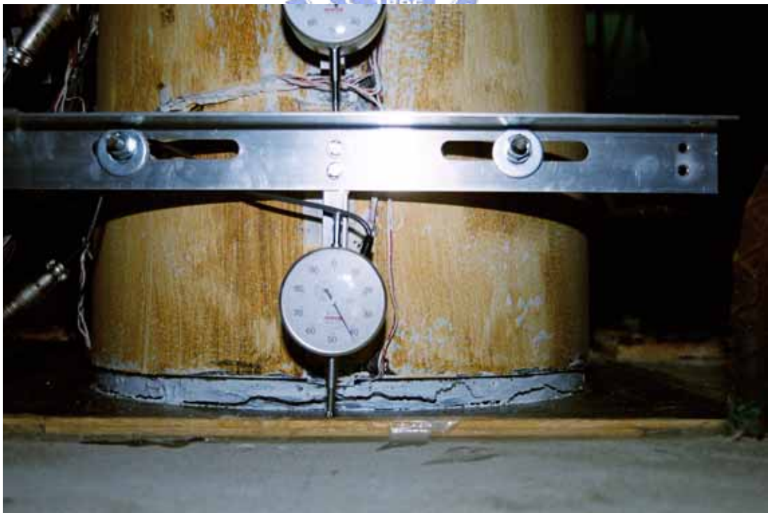
照片 3.22 試體 SP1 柱底部撓曲裂縫 ( \theta = +0.02 弧度)
