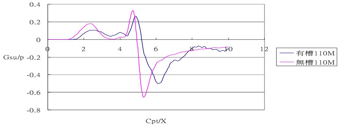
圖 5-13 case II 觀察點 110 公尺處有槽、無槽垂直位移比較
