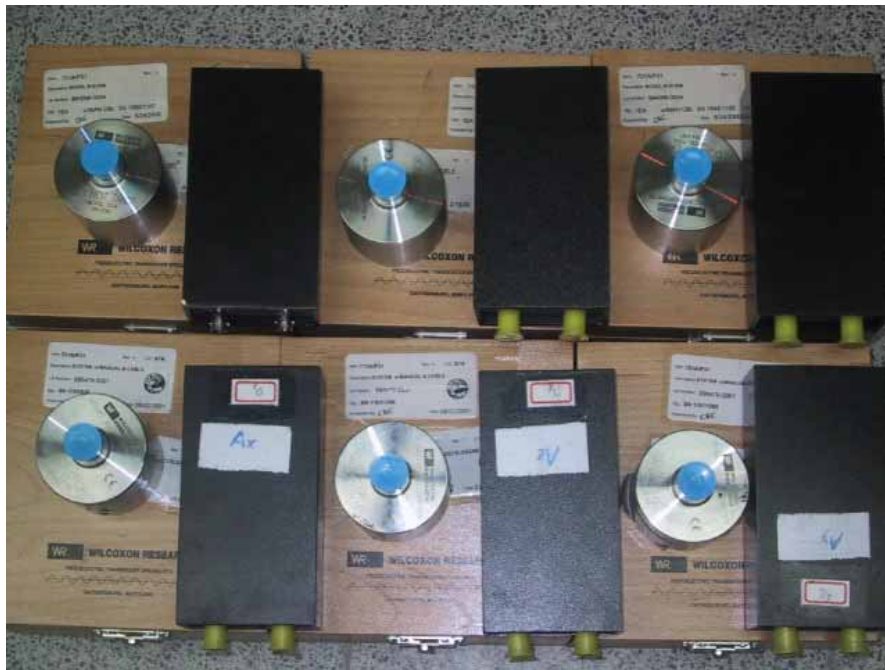
圖 3.12 微振加速規及訊號調節放大器
