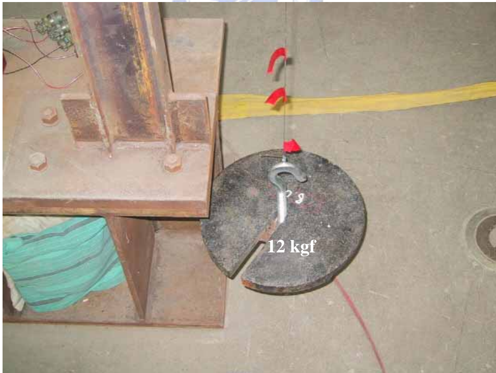
圖 3.15(b) 自由振盪試驗之側向施力示意圖
