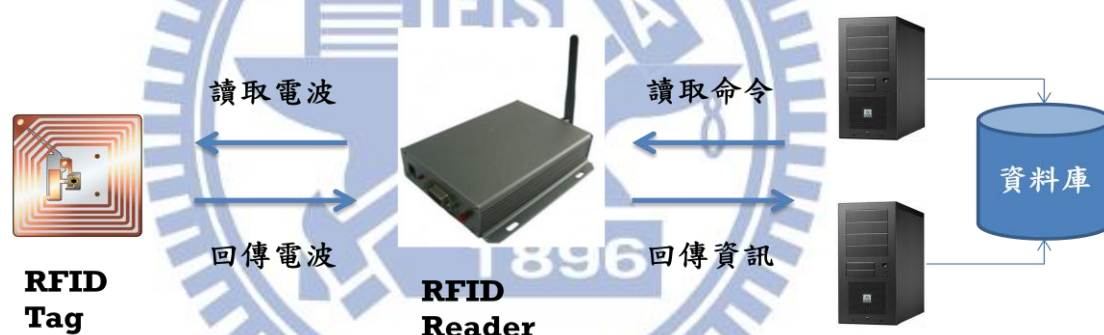
圖 2.1 RFID 運作原理 (資料來源：本研究整理)
