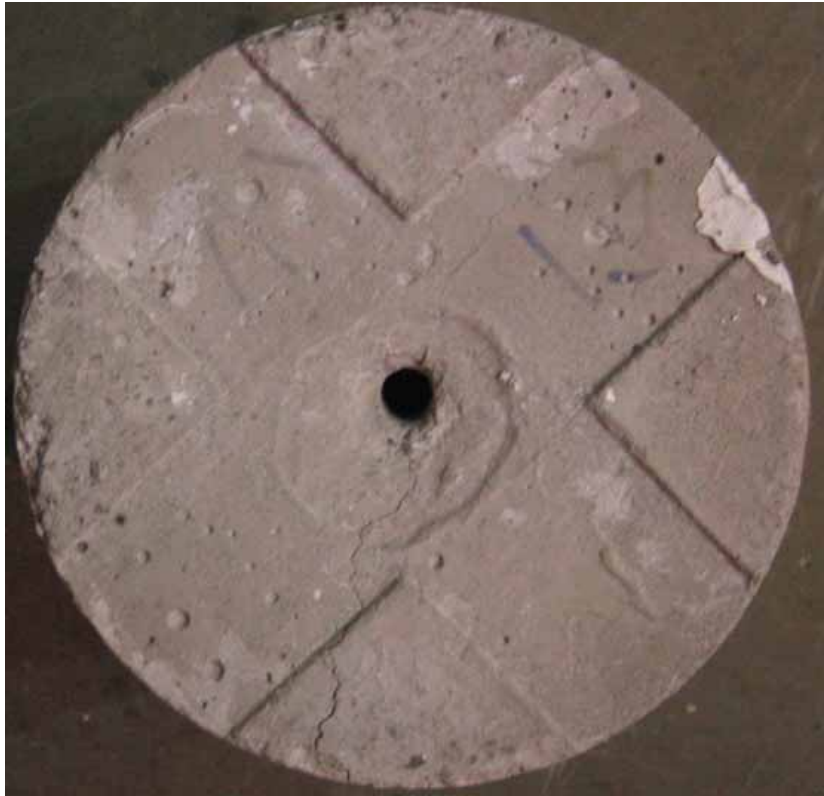
圖 4-7 100°C 下纖維棒直徑 13mm 埋置長度為 4φ 之混凝土試體破壞模式
