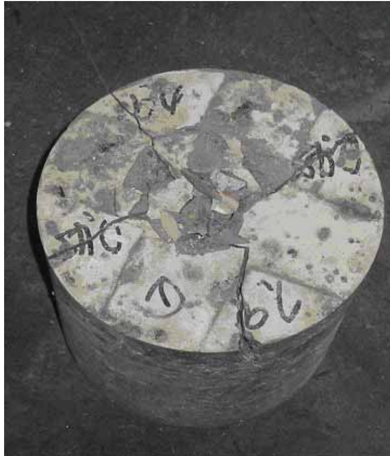
圖 4-13 100°C 下纖維棒直徑 20mm 埋置長度為 4 \phi 之混凝土試體破壞模式
