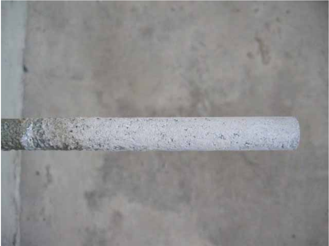
圖 4-28 100°C 下直徑 16mm 之 FRP bar 試體拔出後側視圖
