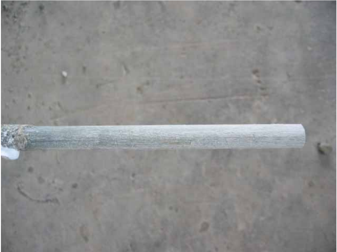
圖 4-32 300°C 下直徑 16mm 之 FRP bar 試體拔出後側視圖
