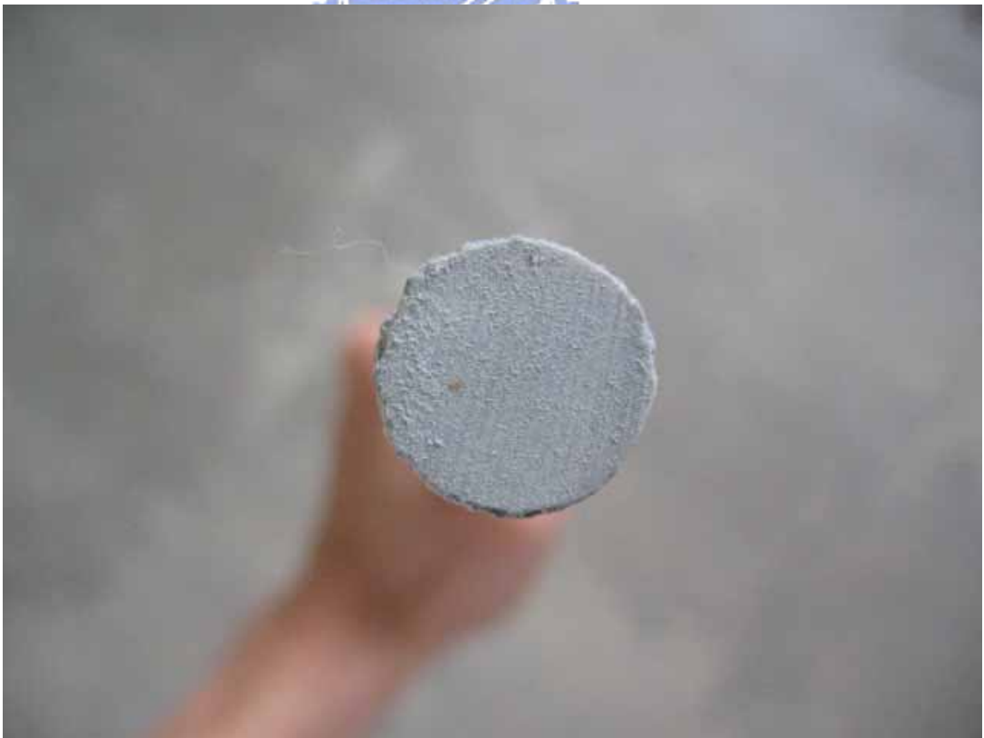
圖 4-29 100°C 下直徑 16mm 之 FRP bar 試體拔出後正視圖
