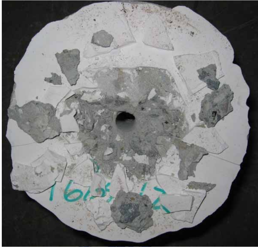
圖 4-3 常溫下纖維棒直徑 16mm 埋置長度為 12\phi 之混凝土試體破壞模式
