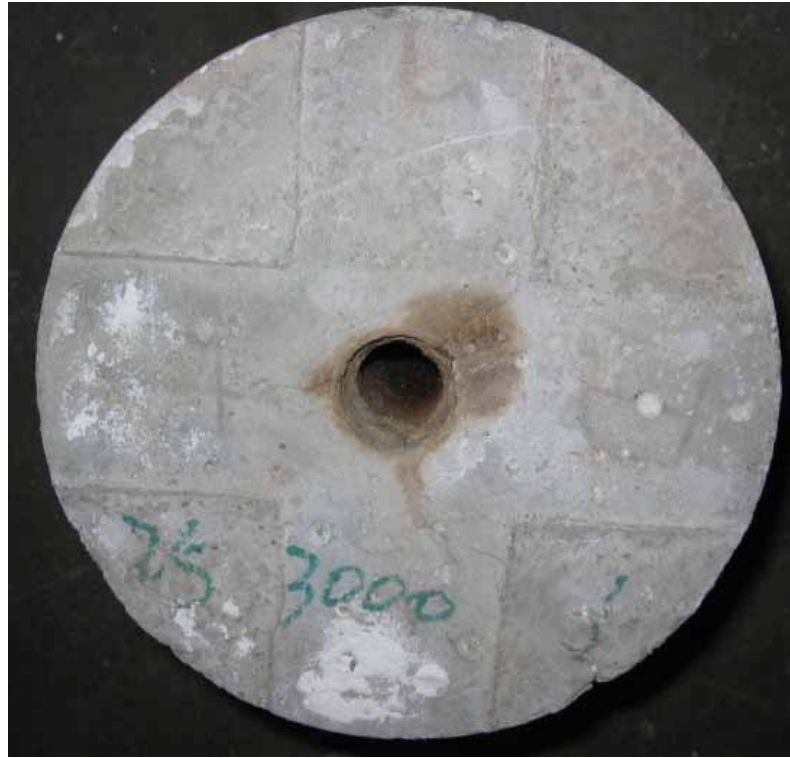
圖 4-25 300°C 下纖維棒直徑 25mm 埋置長度為 4\phi 之混凝土試體破壞模式
