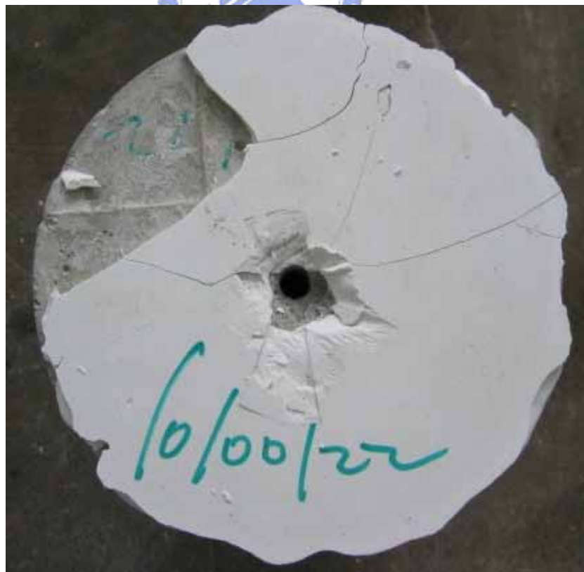
圖 4-6 100°C 下纖維棒直徑 10mm 埋置長度為 12 \phi 之混凝土試體破壞模式
