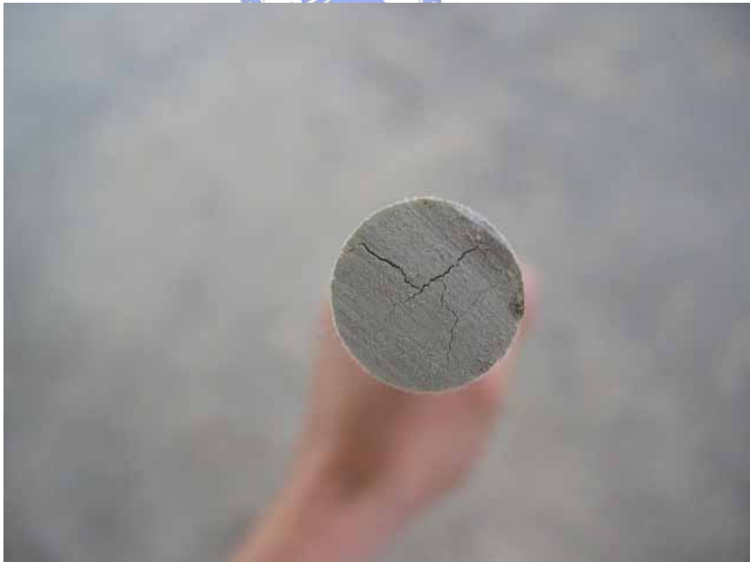
圖 4-33 300°C 下直徑 16mm 之 FRP bar 試體拔出後正視圖
