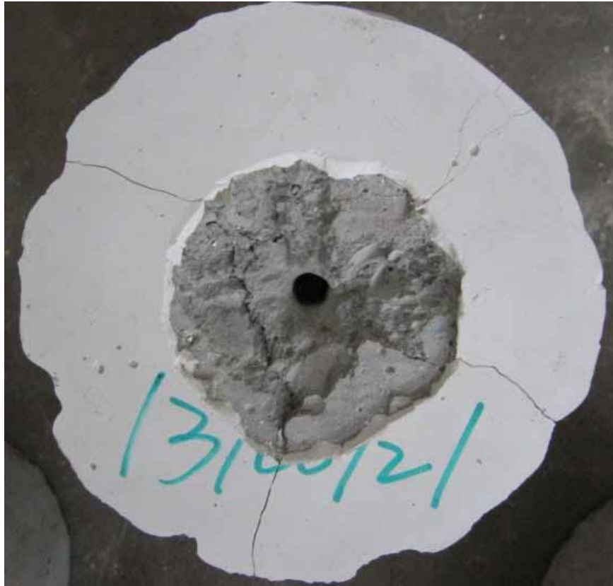
圖 4-9 100°C下纖維棒直徑 13mm 埋置長度為 12 \phi 之混凝土試體破壞模式
