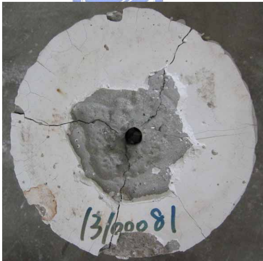
圖 4-8 100°C 下纖維棒直徑 13mm 埋置長度為 8φ 之混凝土試體破壞模式
