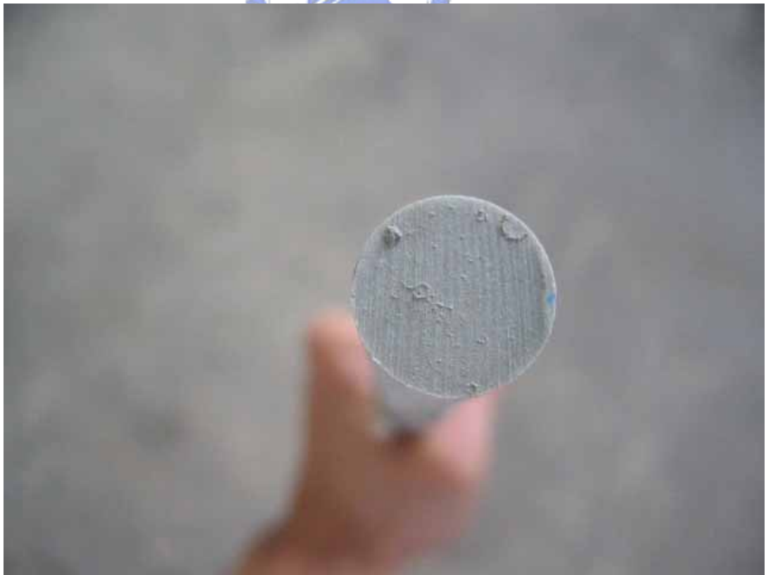
圖 4-31 200°C 下直徑 16mm 之 FRP bar 試體拔出後正視圖
