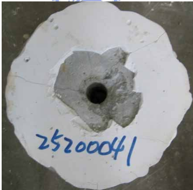
圖 4-20 200°C 下纖維棒直徑 25mm 埋置長度為 4 \phi 之混凝土試體破壞模式
