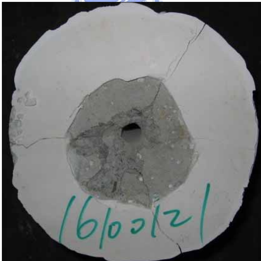
圖 4-12 100°C 下纖維棒直徑 16mm 埋置長度為 12 \phi 之混凝土試體破壞模式
