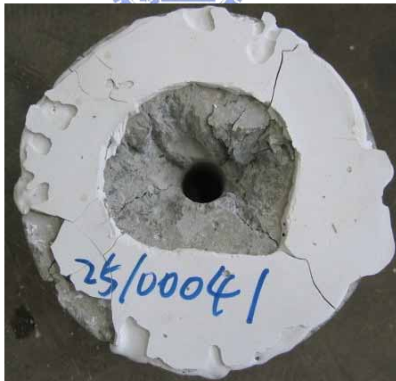
圖 4-14 100°C 下纖維棒直徑 25mm 埋置長度為 4 \phi 之混凝土試體破壞模式
