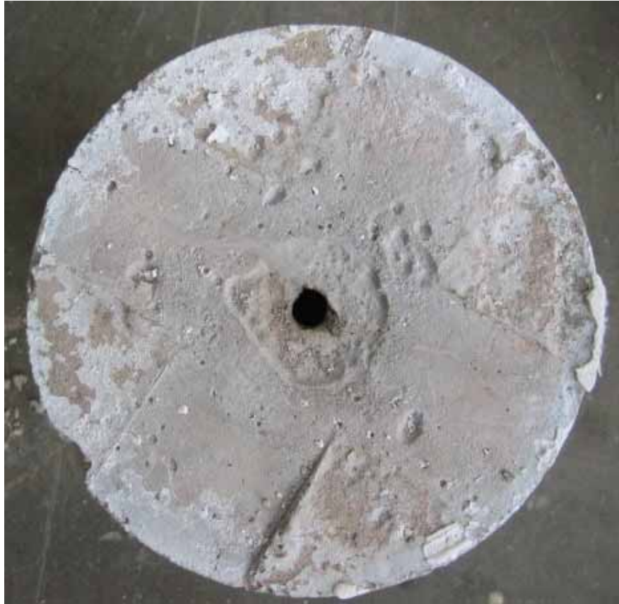
圖 4-17 200°C 下纖維棒直徑 13mm 埋置長度為 4 \phi 之混凝土試體破壞模式
