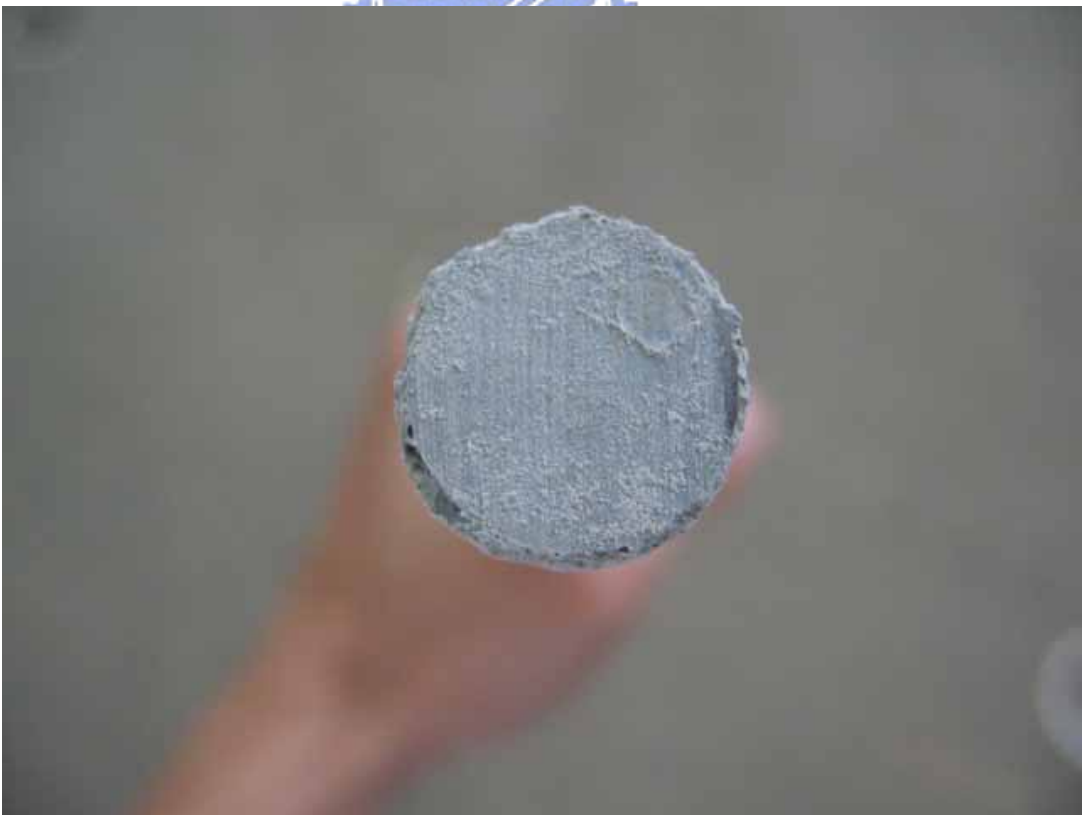
圖 4-27 常溫下直徑 16mm 之 FRP bar 試體拔出後正視圖
