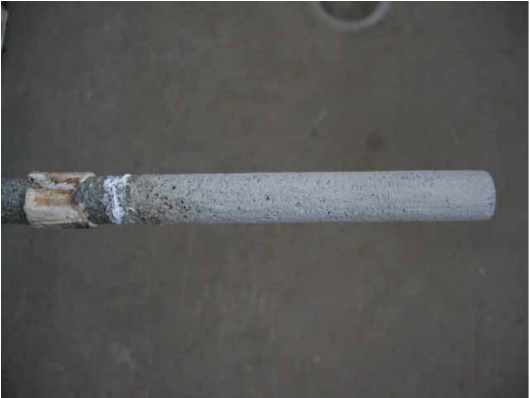
圖 4-26 常溫下直徑 16mm 之 FRP bar 試體拔出後側視圖
