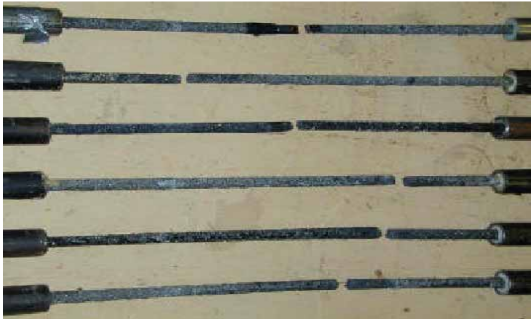
圖 2-3 文獻中 CFRP 試驗試體斷裂情形【5】
