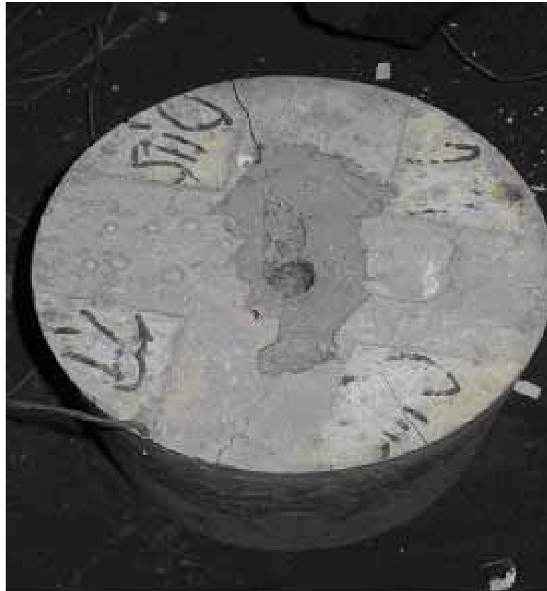
圖 4-19 200°C 下纖維棒直徑 20mm 埋置長度為 4 \phi 之混凝土試體破壞模式
