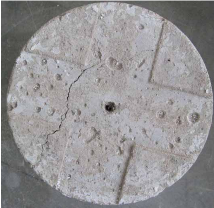
圖 4-21 300°C 下纖維棒直徑 10mm 埋置長度為 4 \phi 之混凝土試體破壞模式
