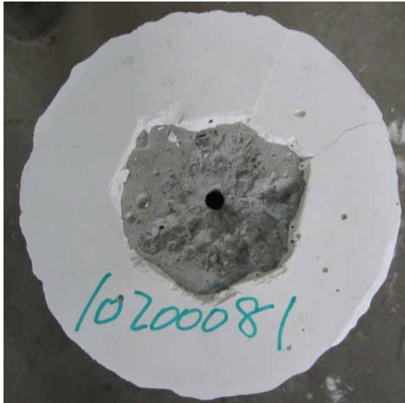
圖 4-15 200°C 下纖維棒直徑 10mm 埋置長度為 8 \phi 之混凝土試體破壞模式
