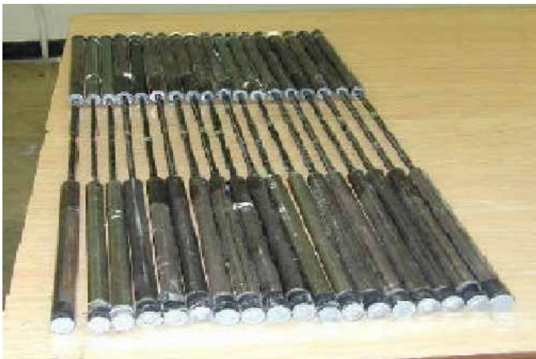
圖 2-1 文獻中 CFRP 的拉力性質試驗試體【5】
