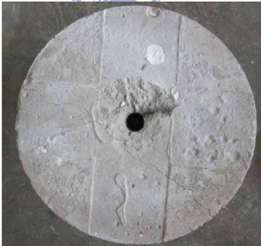
圖 4-10 100°C下纖維棒直徑 16mm 埋置長度為 4 \phi 之混凝土試體破壞模式
