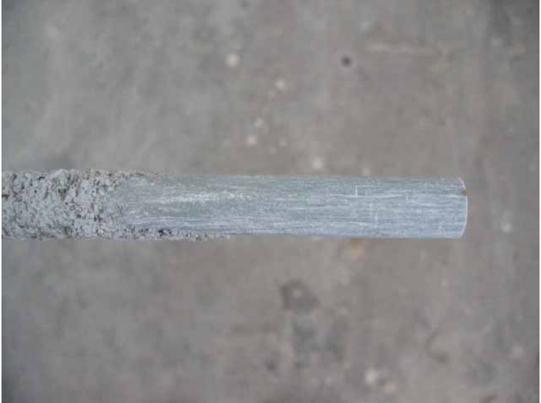
圖 4-30 200°C 下直徑 16mm 之 FRP bar 試體拔出後側視圖
