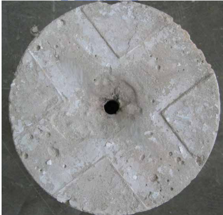
圖 4-22 300°C 下纖維棒直徑 13mm 埋置長度為 4 \phi 之混凝土試體破壞模式
