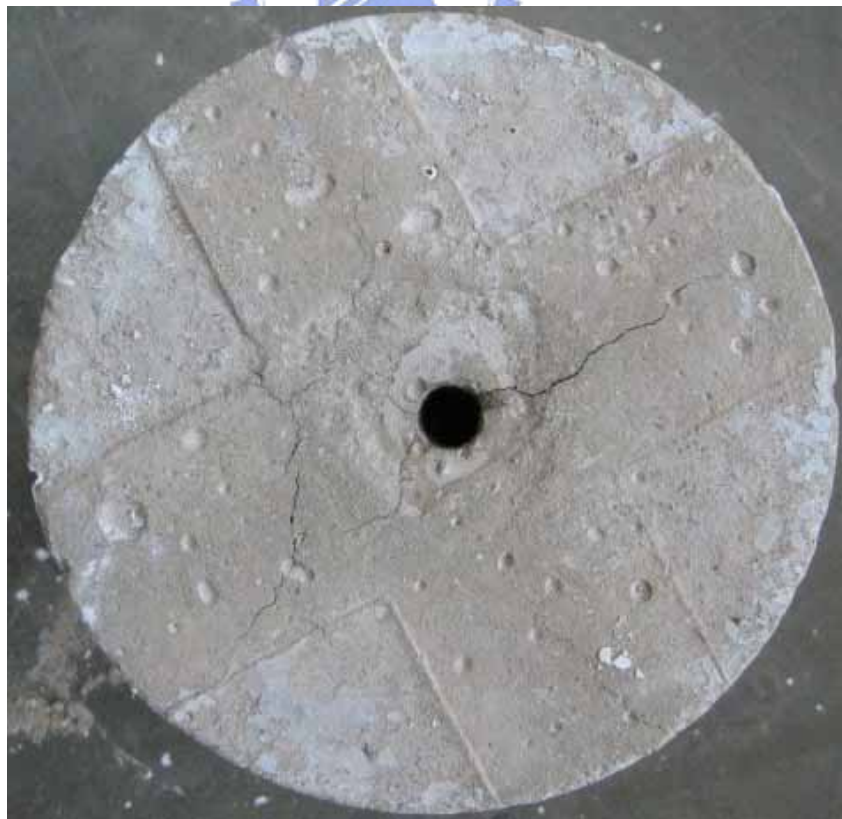
圖 4-18 200°C 下纖維棒直徑 16mm 埋置長度為 4 \phi 之混凝土試體破壞模式
