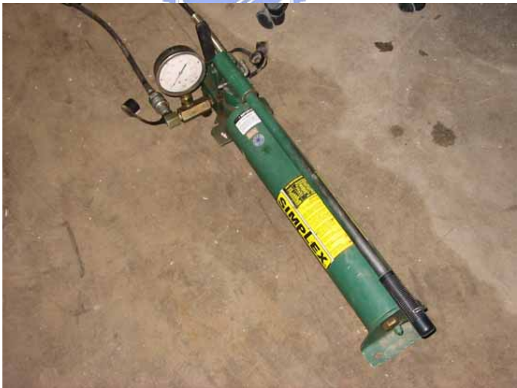
圖3-4 手動式油壓機
