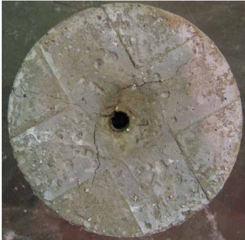
圖 4-23 300°C 下纖維棒直徑 16mm 埋置長度為 4\phi 之混凝土試體破壞模式
