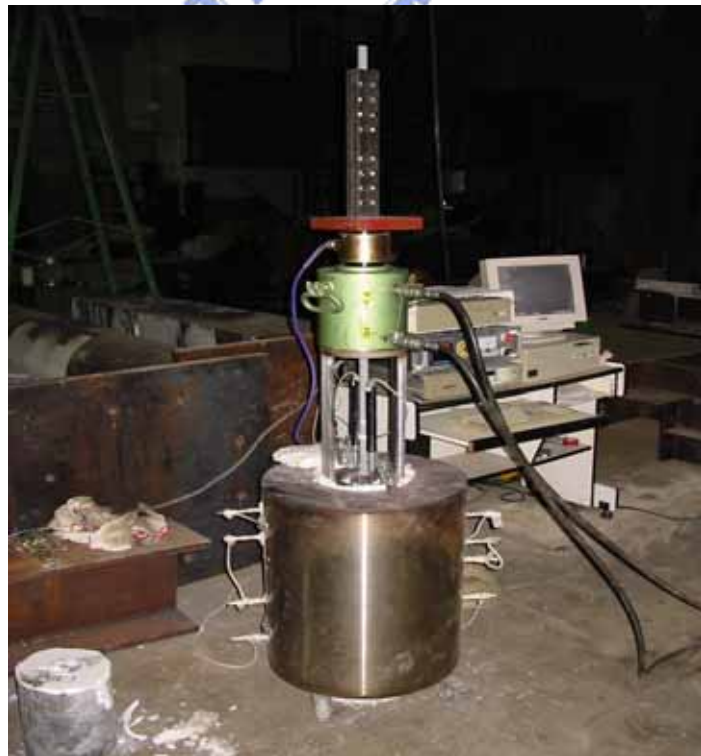
圖3-8 拉拔試驗設備及試體支承系統(實體圖)
