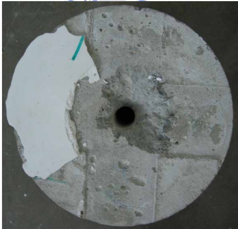
圖 4-4 常溫下纖維棒直徑 20mm 埋置長度為 12\phi 之混凝土試體破壞模式
