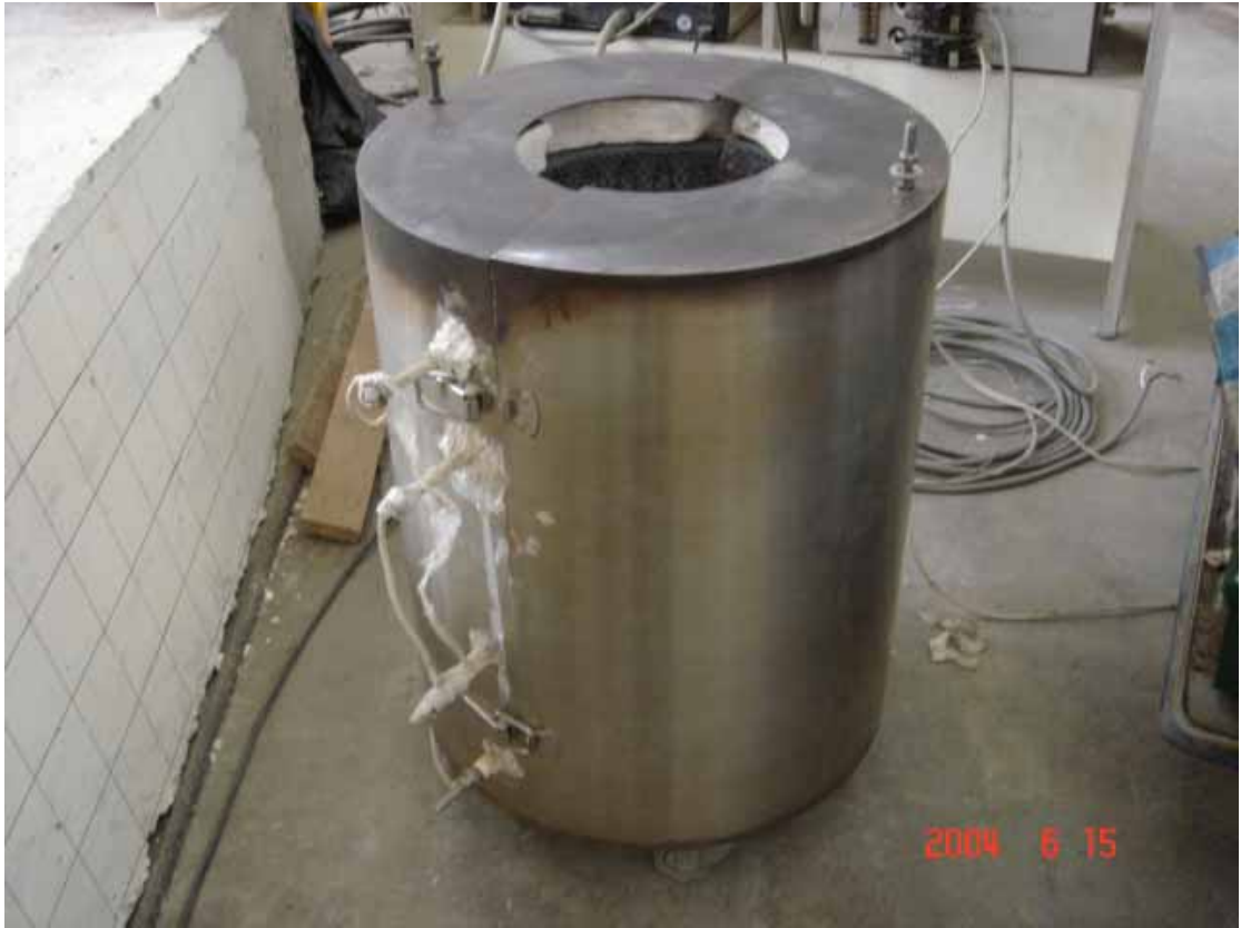
圖 3-5 電熱式圓桶高溫爐
