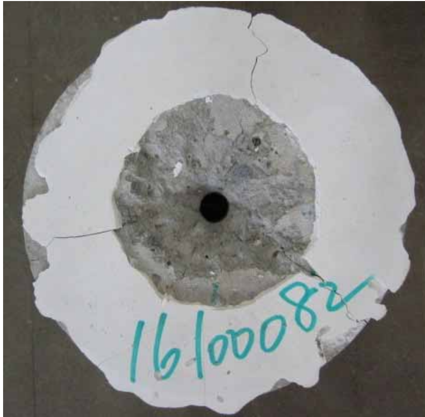
圖 4-11 100°C 下纖維棒直徑 16mm 埋置長度為 8 \phi 之混凝土試體破壞模式
