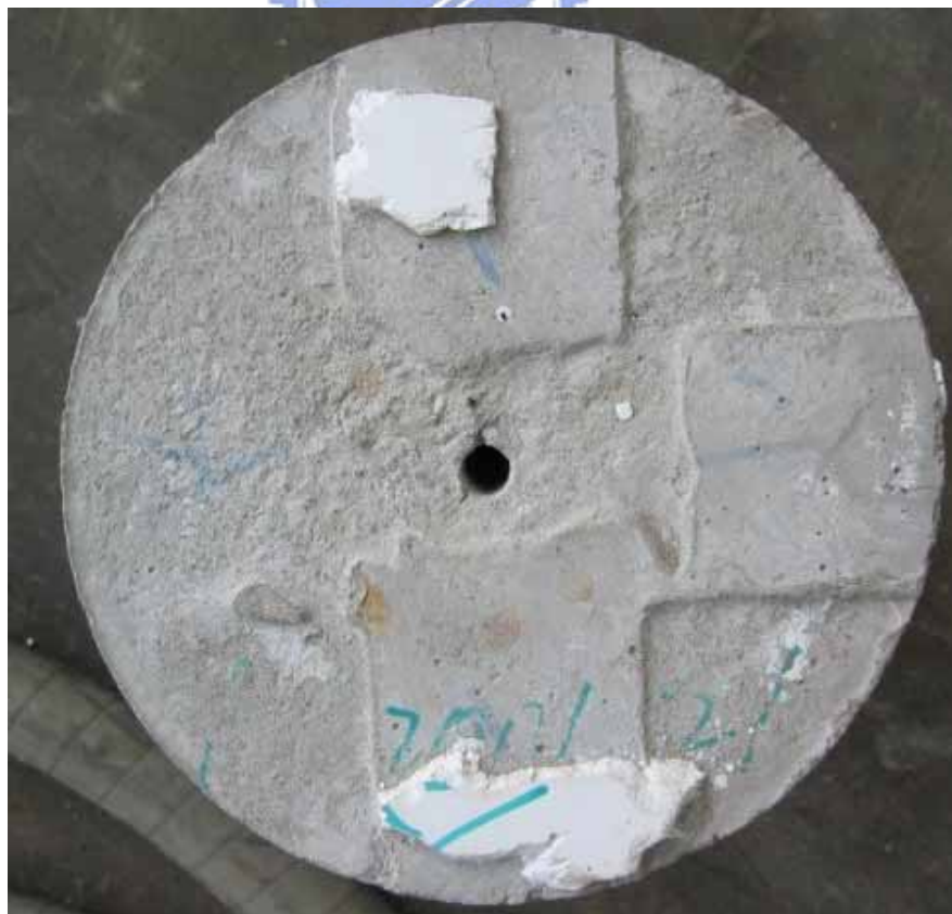
圖 4-16 200°C 下纖維棒直徑 10mm 埋置長度為 12 \phi 之混凝土試體破壞模式
