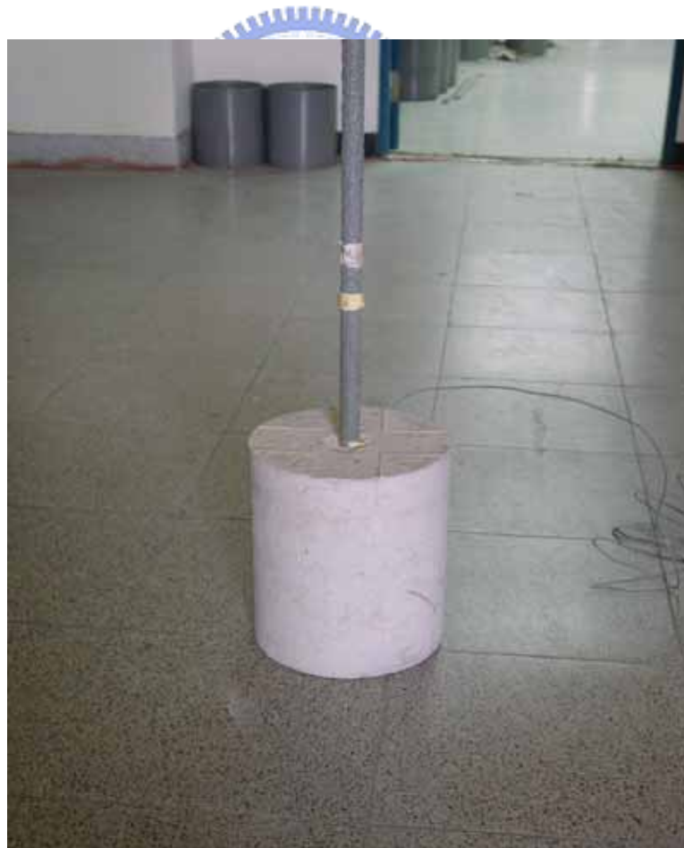
圖 3-2 握裹力試驗試體之規格 (實體)
