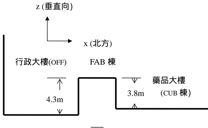
圖 2.3 奈米元件實驗室基礎和側牆剖面示意圖
