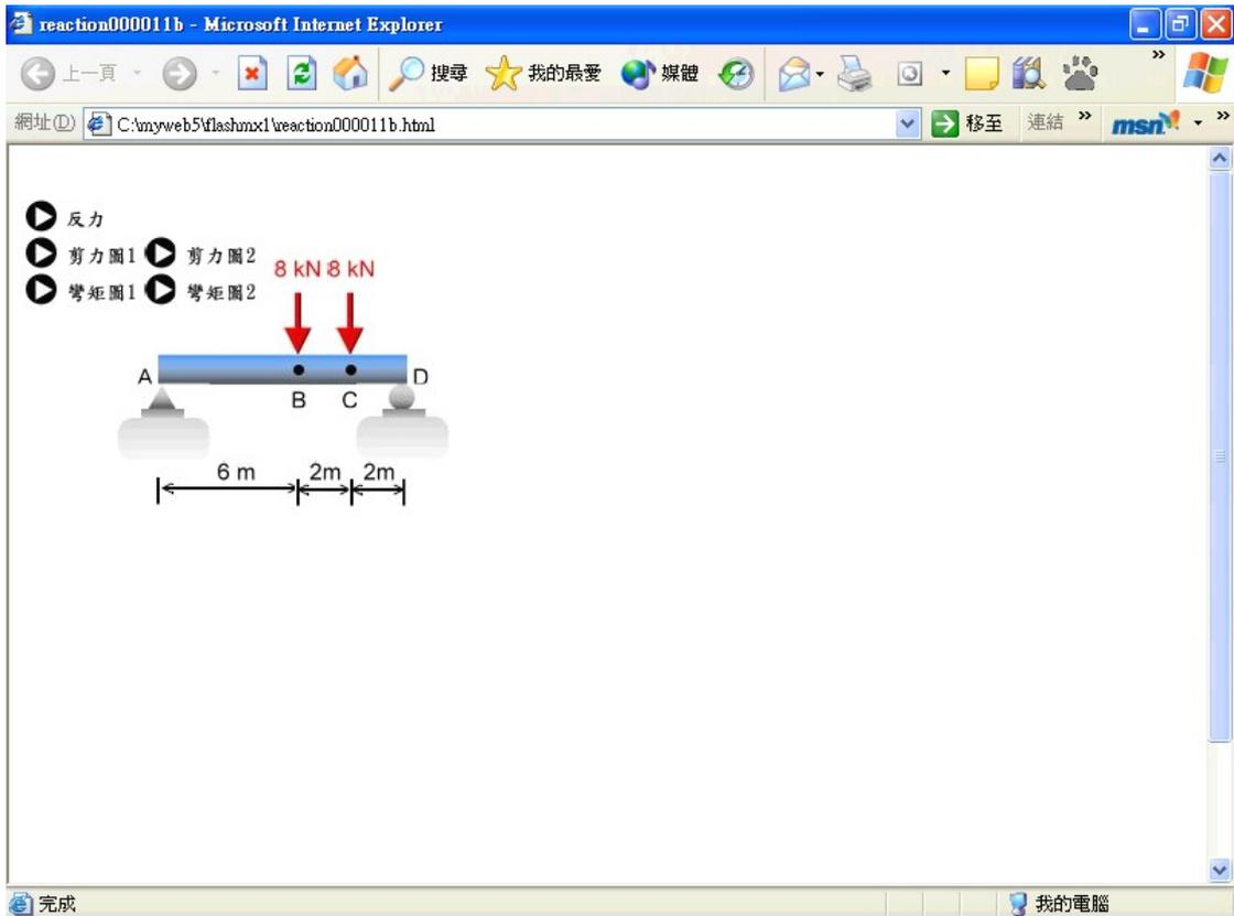
圖 5-14 求解梁之剪力與彎矩圖
