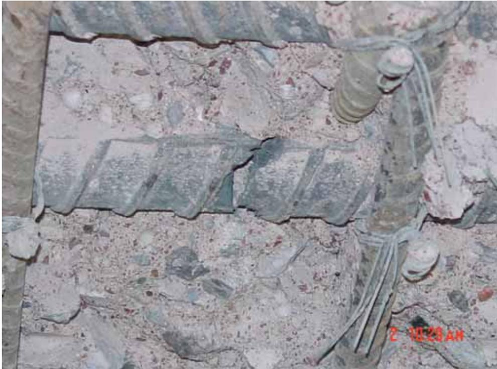
照片 三十三 6cm 偏心試體梁主鋼筋斷裂(一)
