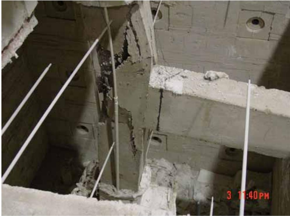
照片 二十五 5cm 偏心試體破壞側視圖 (一)
