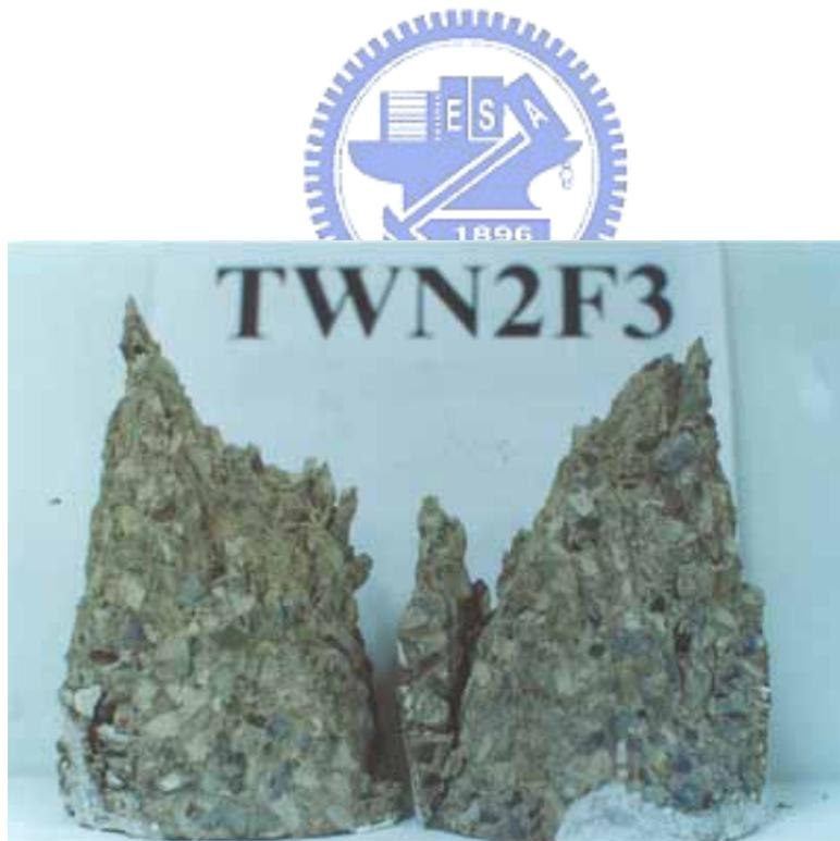
照片 二 高溫圓柱試體破壞模式
