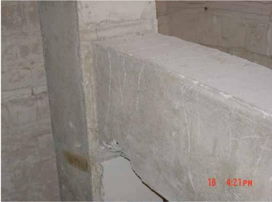
照片 三十七 水平殘餘抵抗力試驗參考試體破壞 (三)
