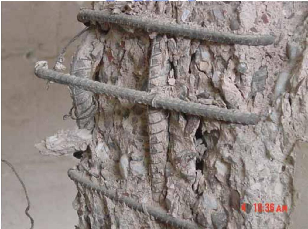
照片 二十八 5cm 偏心試體破壞區放大圖 (一)
