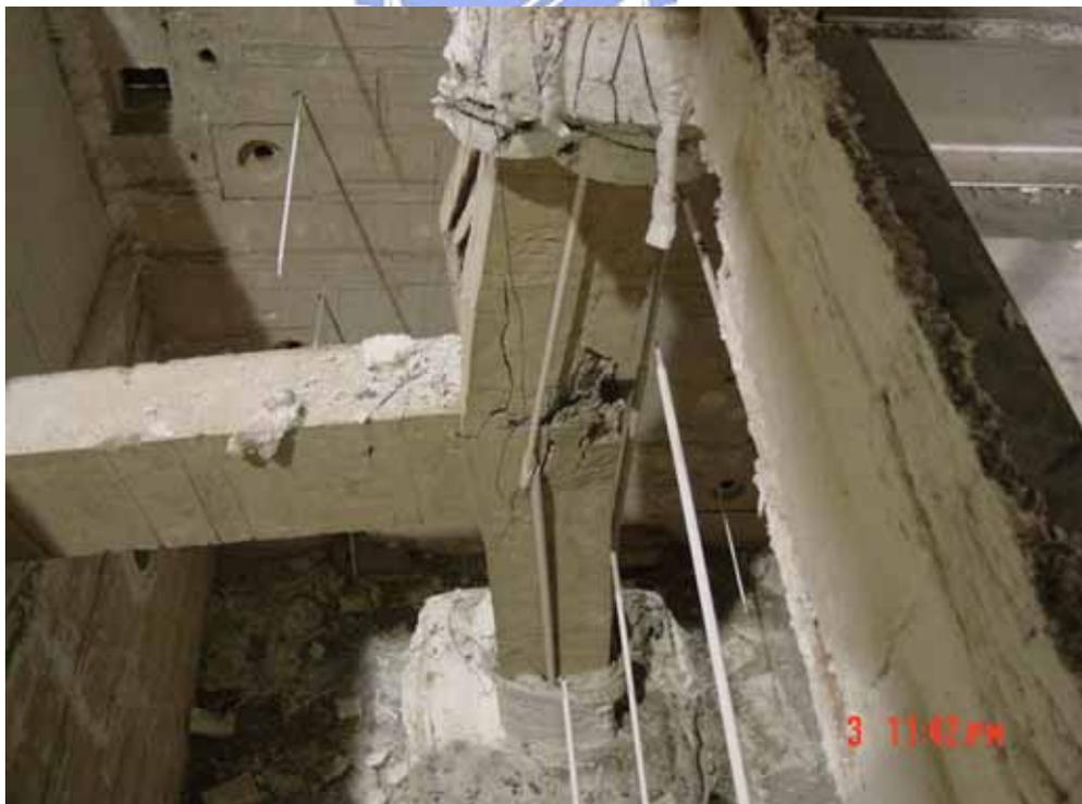
照片 二十六 5cm 偏心試體破壞側視圖 (二)
