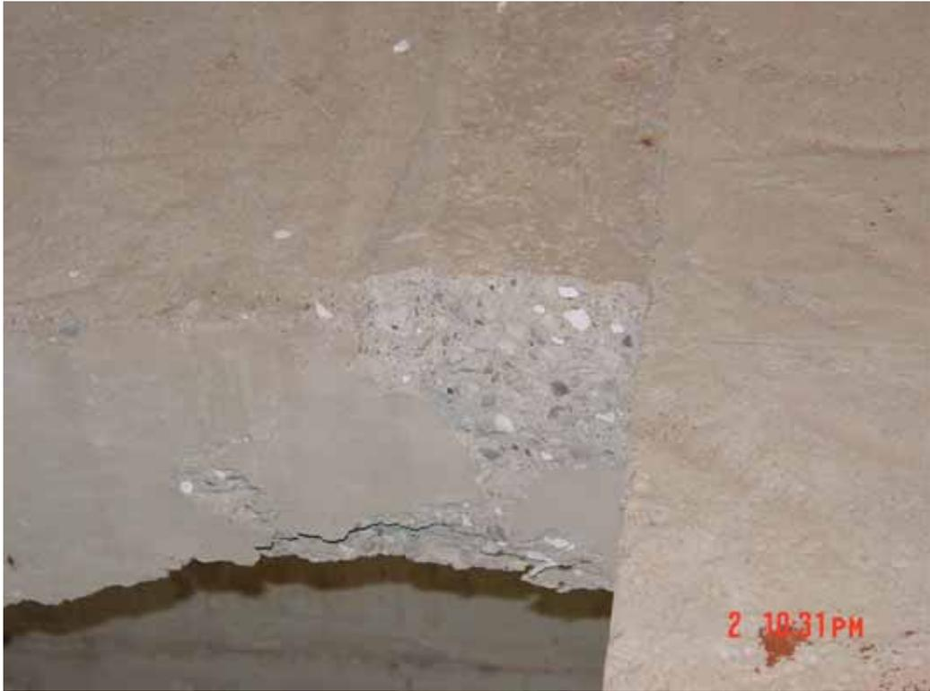
照片 三十九 水平殘餘抵抗力試驗試體一之梁底
