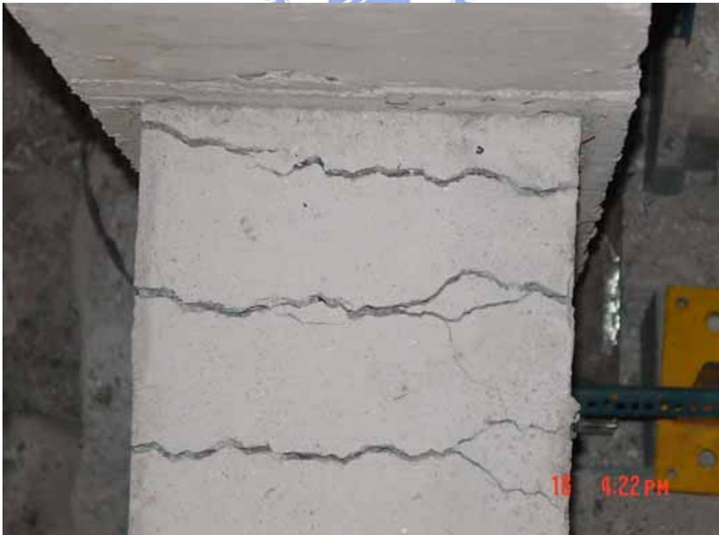
照片 三十六 水平殘餘抵抗力試驗參考試體破壞 (二)
