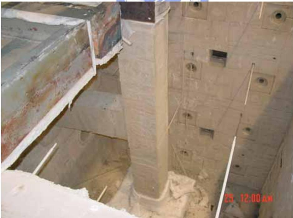
照片 三十 6cm 偏心試體柱在試驗後之側視(一)
