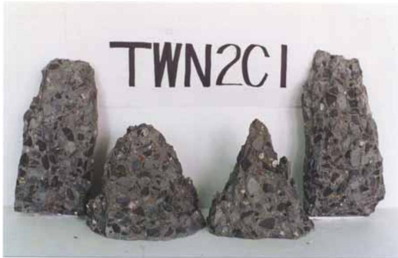
照片 一 低溫圓柱試體破壞模式
