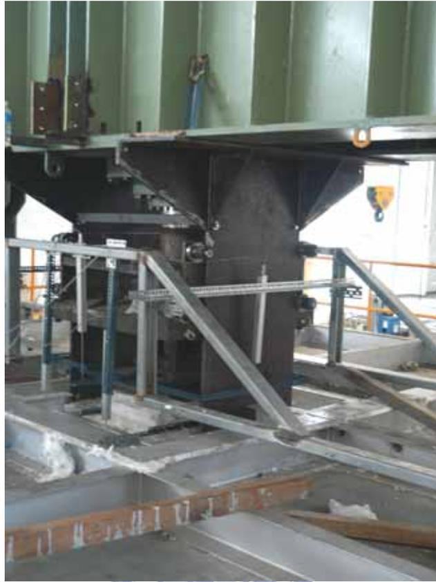
照片 二十一 油壓機水平力保護裝置
