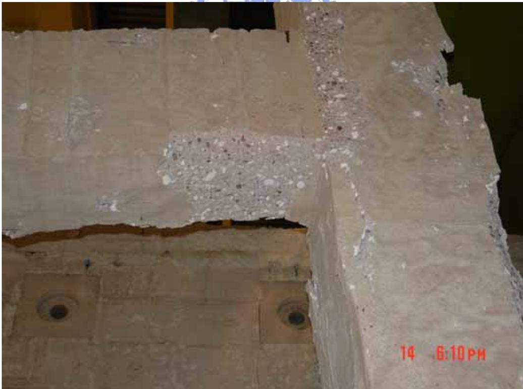
照片 四十二 水平殘餘抵抗力試驗試體二加壓後
