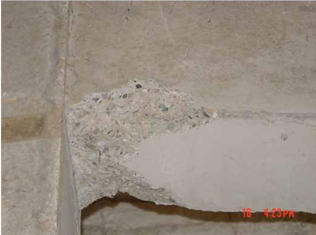
照片 三十五 水平殘餘抵抗力試驗參考試體破壞 (一)
