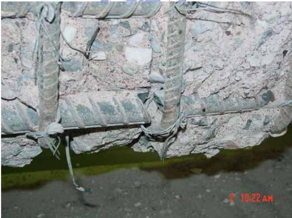
照片 三十四 6cm 偏心試體梁主鋼筋斷裂(二)
