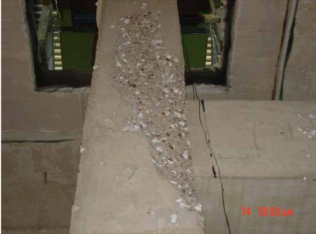
照片 四十一 水平殘餘抵抗力試驗試體二加壓前之柱
