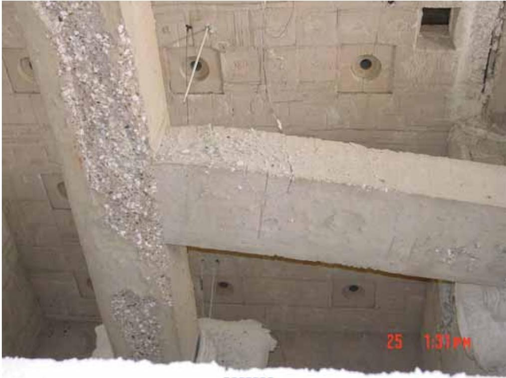
照片 三十一 6cm 偏心試體柱在試驗後之側視(二)
