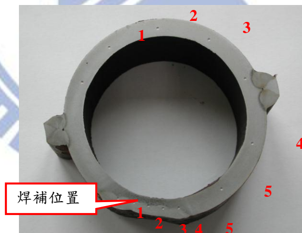
圖 1：爐管斷面母材與焊補硬度量測位置。
