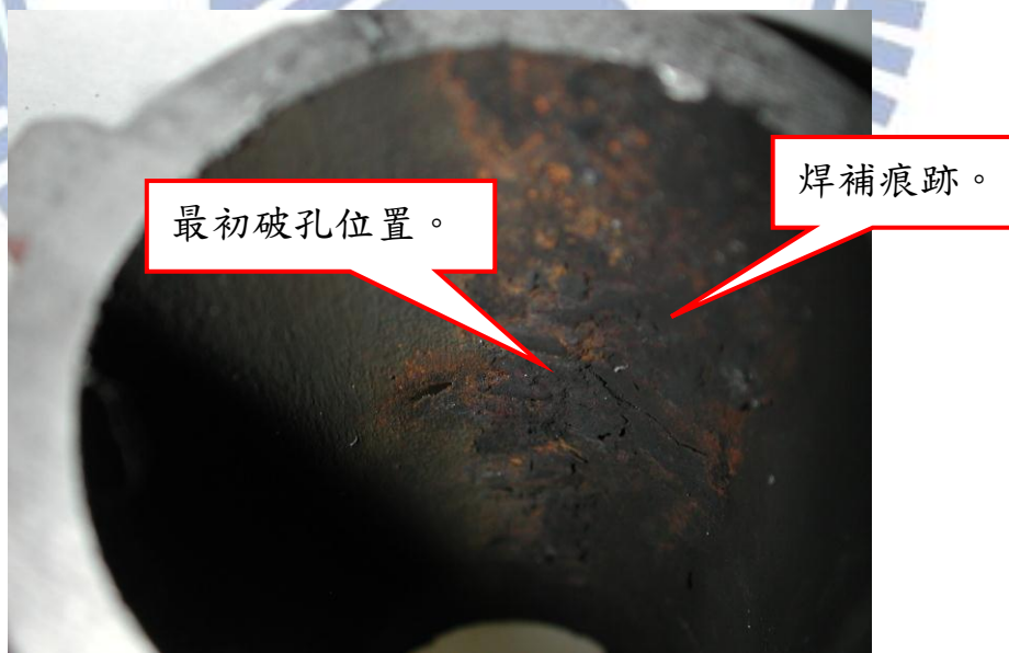
圖 5：最初之破孔位置剛好在焊補痕跡的一緣，該位置可能是起焊端或是止焊端。
