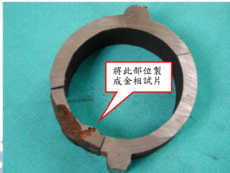
圖 8：將試體再細切製成金相分析用試片。
