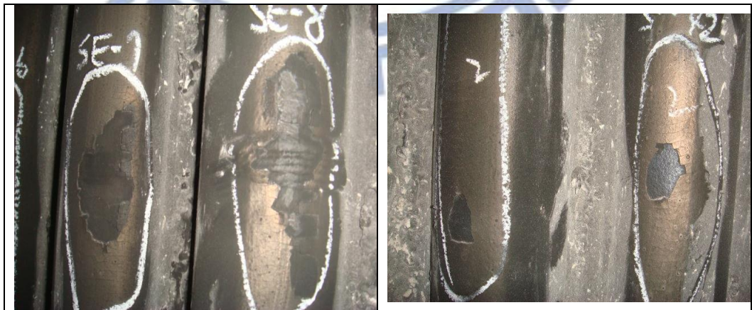
圖 37 爐管 Coating 剝落照片[17]
