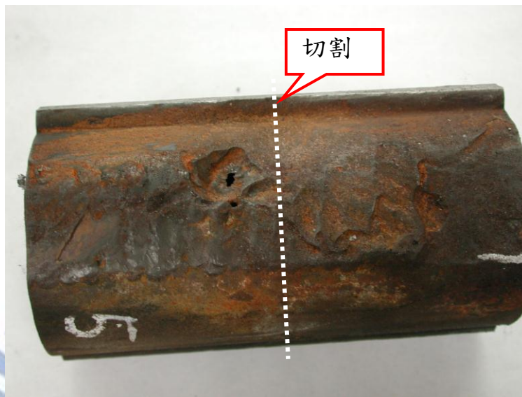
圖 6：將最初之破孔位置做切割以利做進一步觀察。
