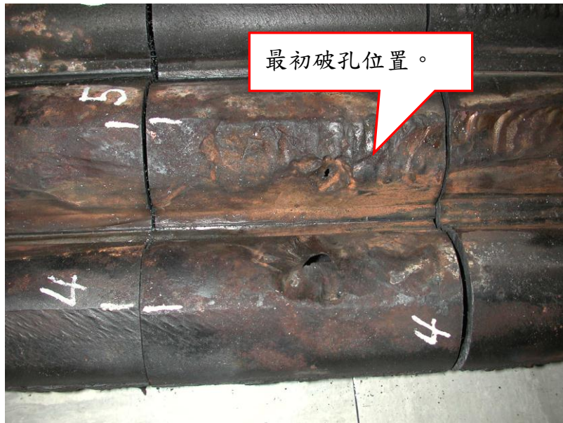
圖 4：將水牆管試體做切割以利做進一步觀察。
