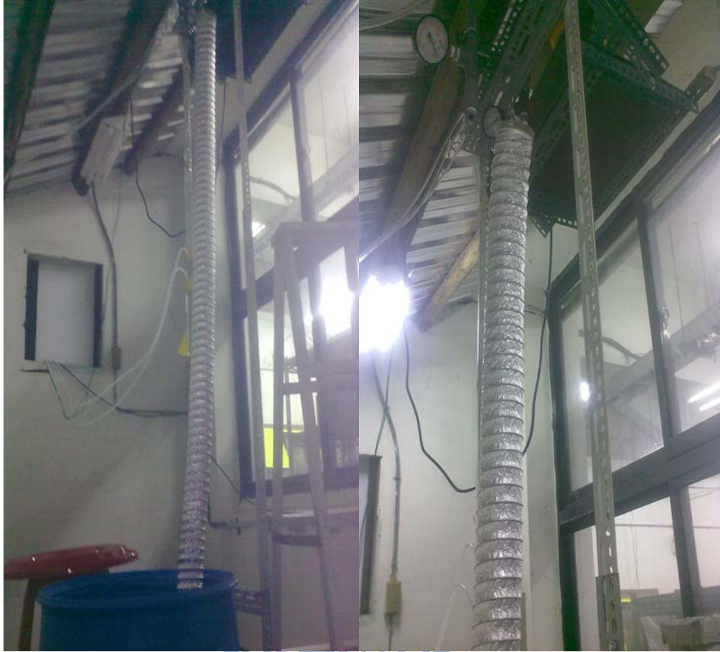
圖 19 細水霧 50、30、20 kg/cm 2 噴灑壓力採集量測實際流量
