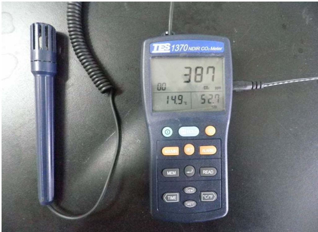
圖 11 TES-1370 二氧化碳偵測儀器
