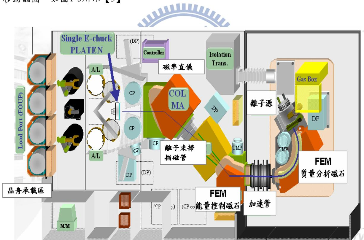
圖 1-5 離子佈植機台結構及元件【3】
