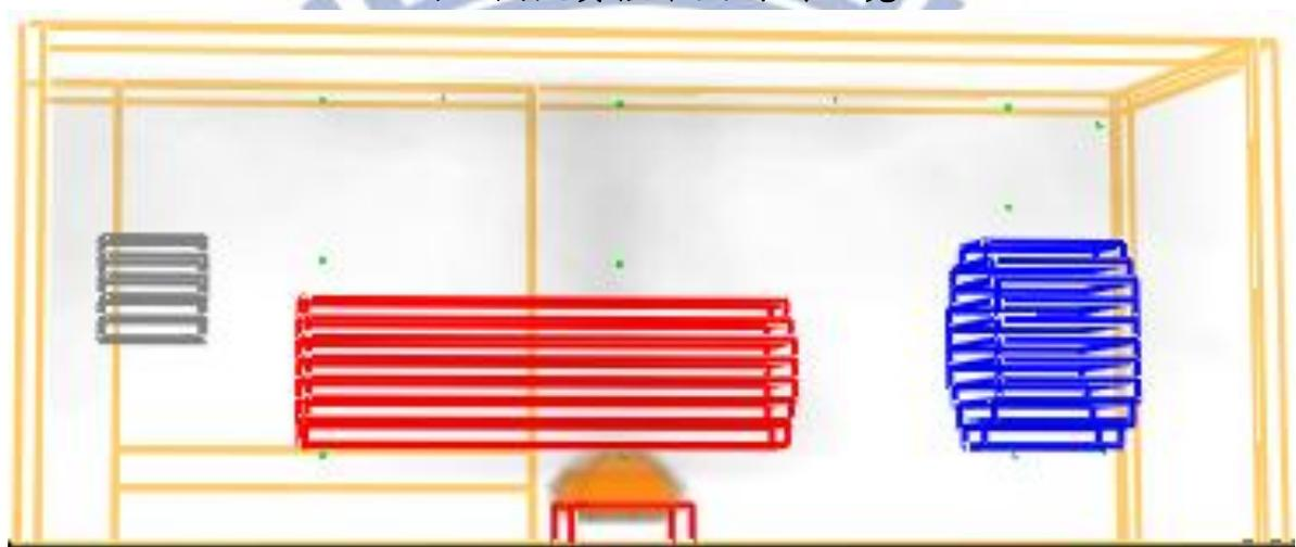
圖72 模擬遮蔽物中央下面封閉燃燒
