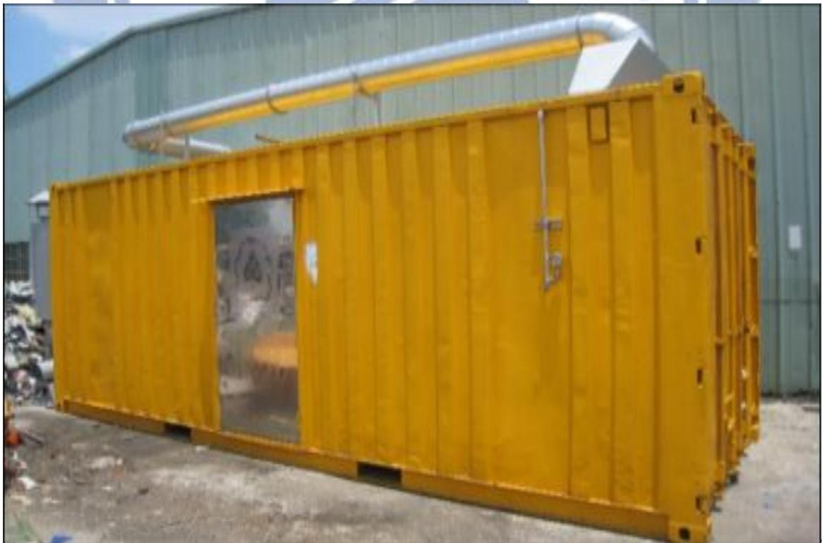
圖 15 以貨櫃模擬風力發電機機艙
