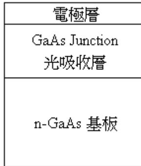
圖 2-8：GaAs 單接面太陽能電池結構 [6]
