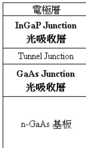
圖 2-10：GaAs/InGaP 二接面太陽能電池結構 [6]
