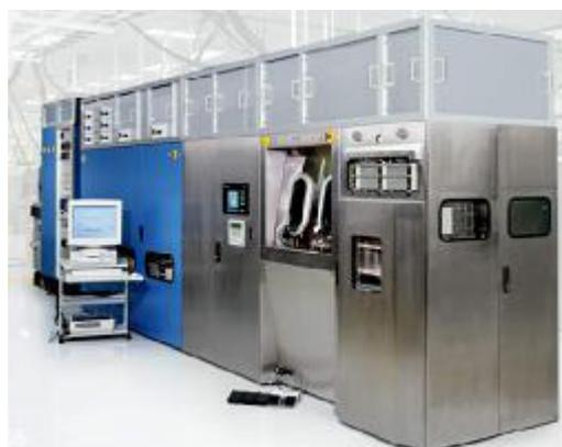
圖 4-2：MOCVD(Aixtron 2600)系統設備圖 [37]
