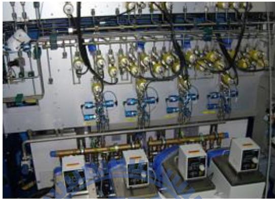
圖 4-4：MOCVD 流量控制器管路面盤 [37]
