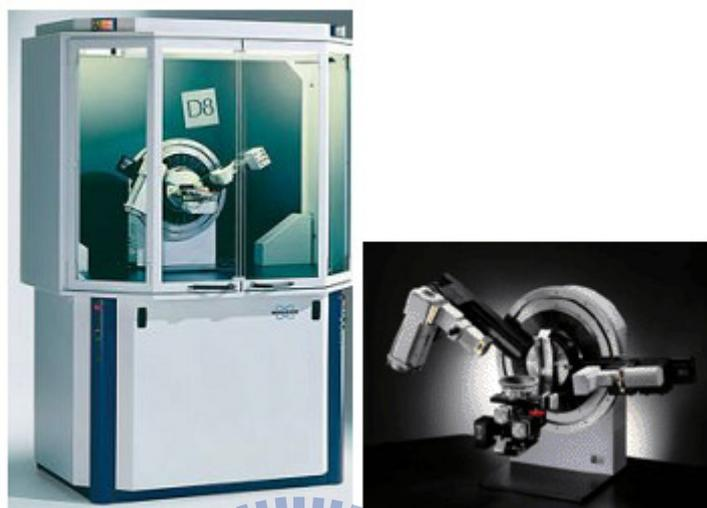
圖 4-19：X 光繞射儀
