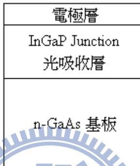
圖 2-9：InGaP 單接面太陽能電池結構 [6]
