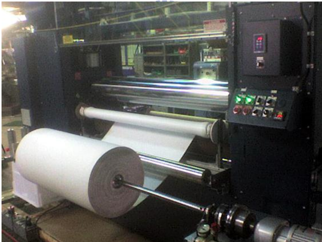
圖 2-2 薄膜延伸成型之機台加工情形
