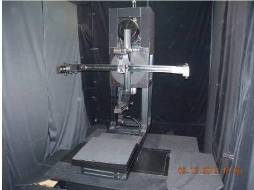
圖 4.4 量測儀器的旋轉台
