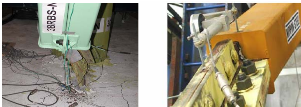
圖 1.3 接合板挫屈 [Tsai et al. (2004)]
