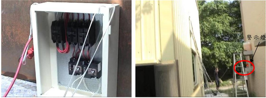
圖 31 漏電實驗箱（左）、警示燈（右）
