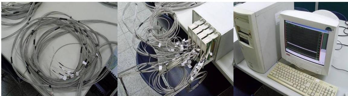
圖 29 熱電偶 (左)、Data Logger (中)、資料接收電腦 (右)
