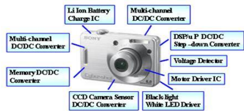
數位相機相關類比 IC 及電源方案示意圖
