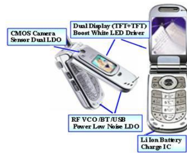
手機相關類比 IC 及電源方案示意圖
