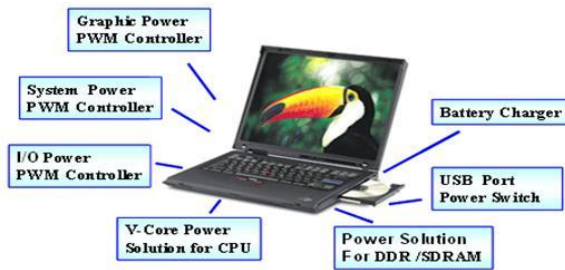
筆記型電腦電源方案示意圖
