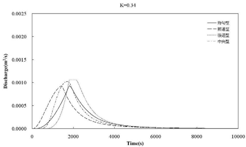
圖 4.1 下游 100 公尺處之單位寬度流量歷線圖(降雨延時為 0.5 小時)
