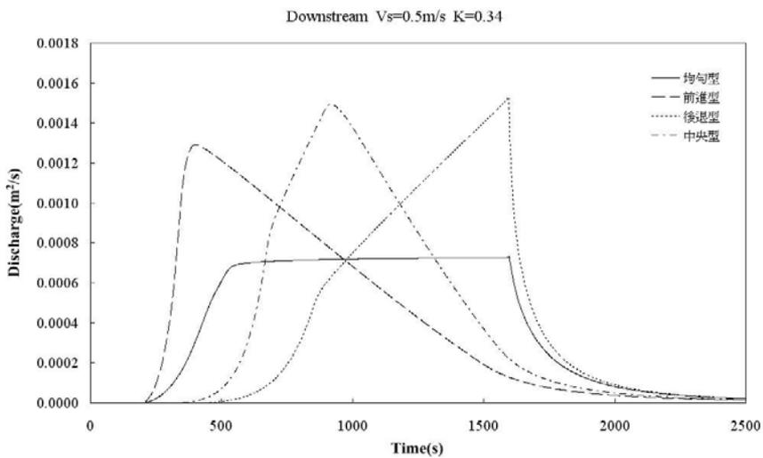
圖 4.17 不同總降雨量下游 100 公尺處之單位寬度流量歷線圖
