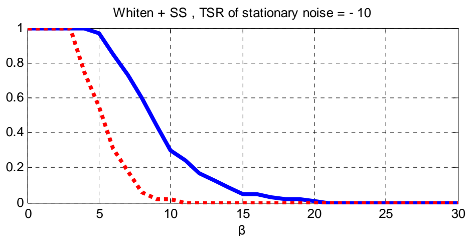
圖 4.7 干擾為 F16 在 TSR=-10 的情況下經過 SS 後 TNAD 的結果
