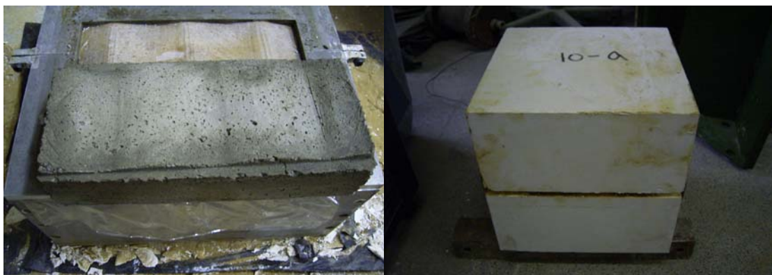
(e)水泥砂漿界面製作完成
