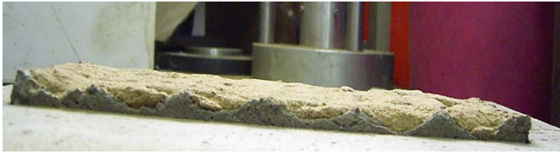
圖 5-6 20°-1 試體受剪後破壞情形(水泥砂漿部分)
