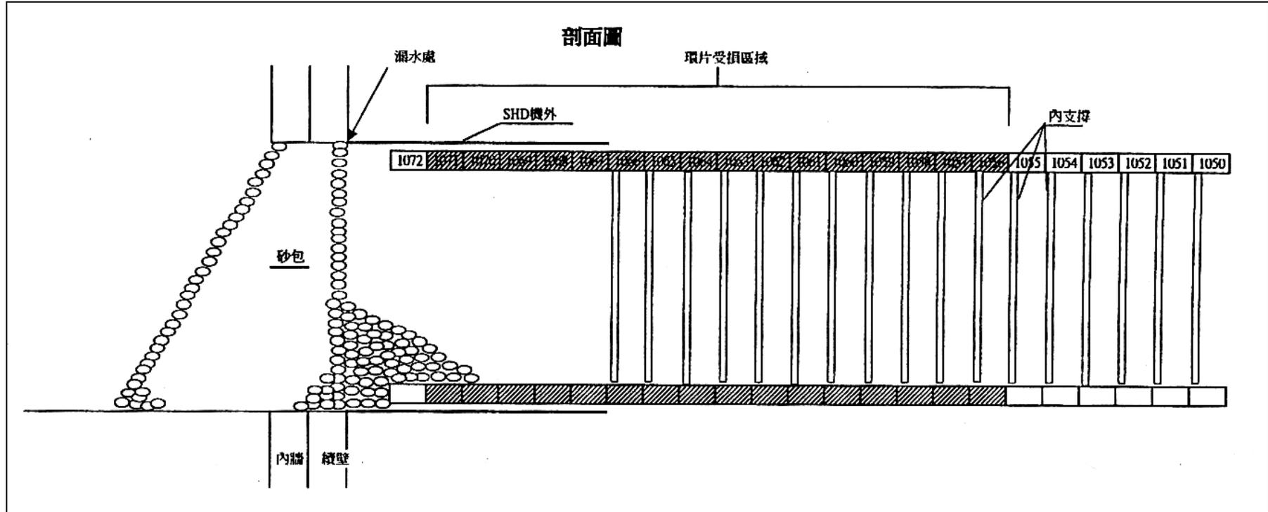
圖 5-17 第一階段坑內止水示意圖砂包堆疊剖面圖
