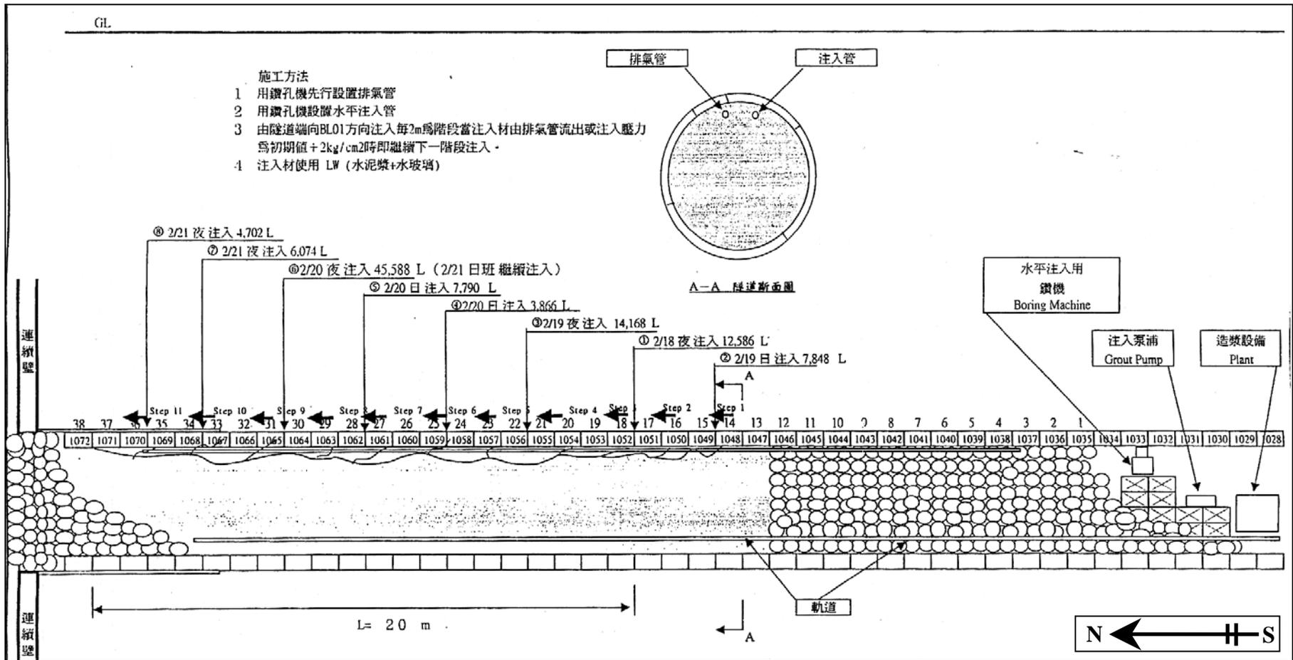
圖 5-27 隧道內水平 LW 注入灌漿作業方式
