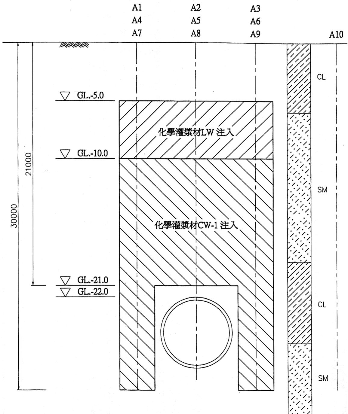
圖 5-29 規劃 A 系列灌漿區斷面
