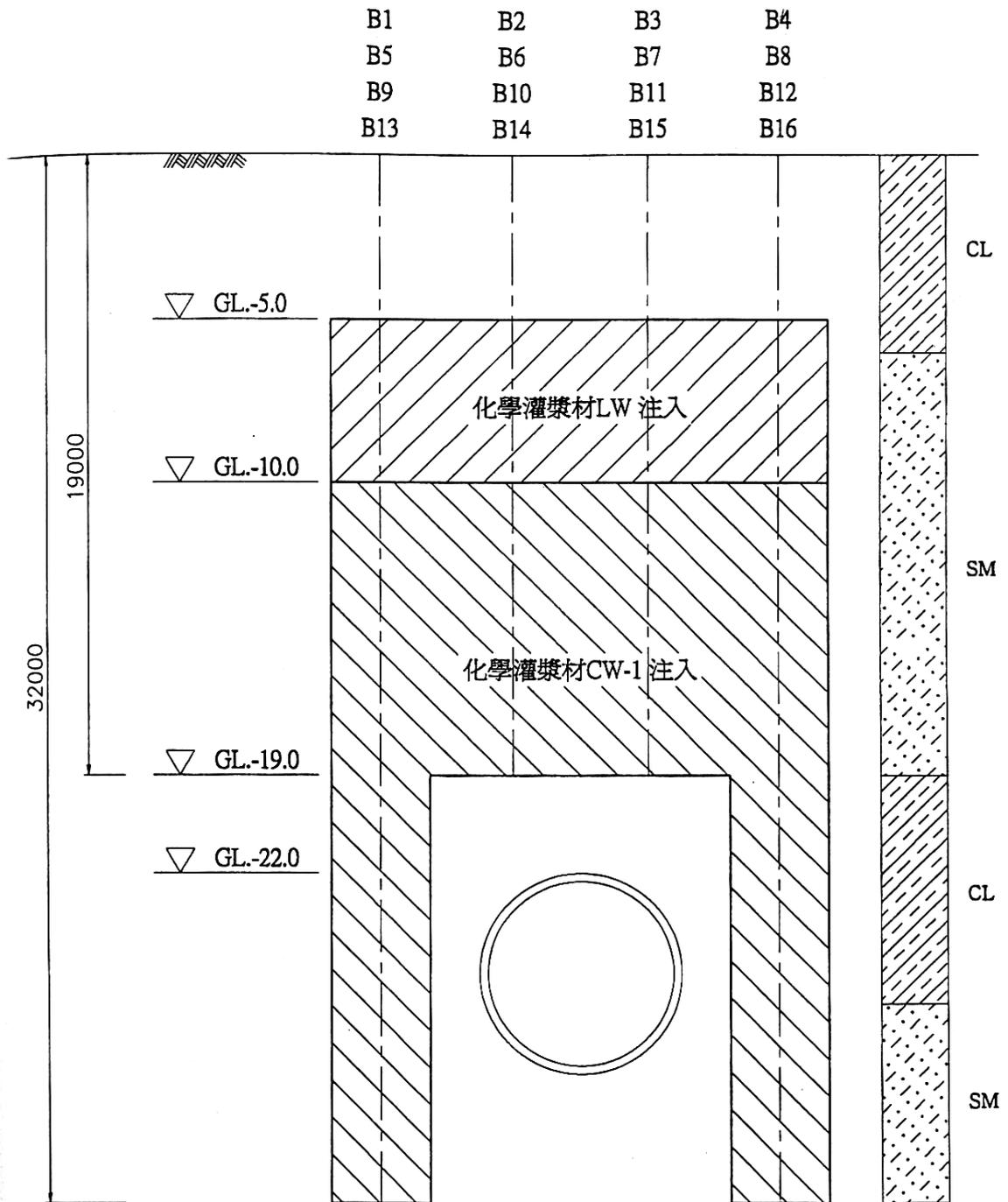
圖 5-31 規劃 B 系列灌漿斷面
