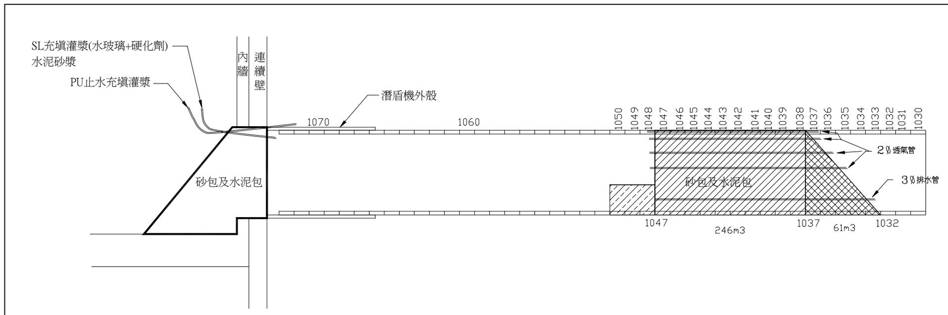
圖 5-26 封堵出水段隧道內灌漿填充示意圖
