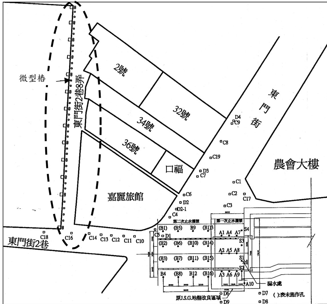
圖 5-32 微型樁佈設圖 (摘自 大陸工程, 2003)
