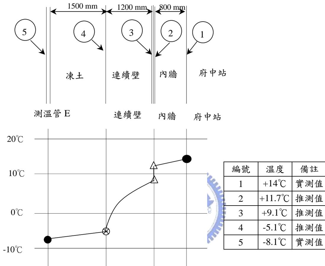
圖 5-77 下行隧道洞口處壁面溫度變化圖
