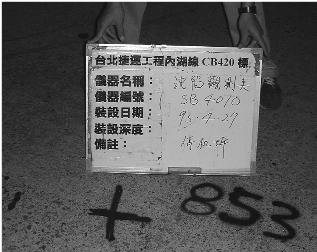
圖 7-16 機場停機坪沉陷觀測點 (SB)
