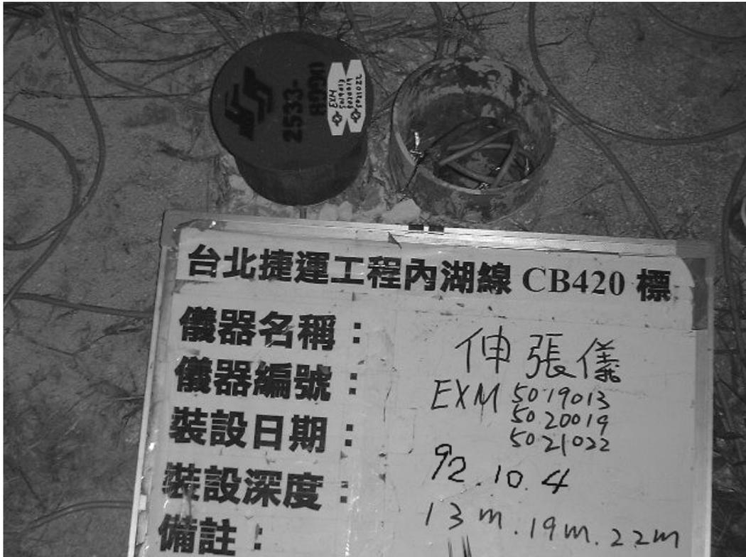
圖 7-23 主跑道南側草坪處多點式桿式伸縮儀 (EXM)
