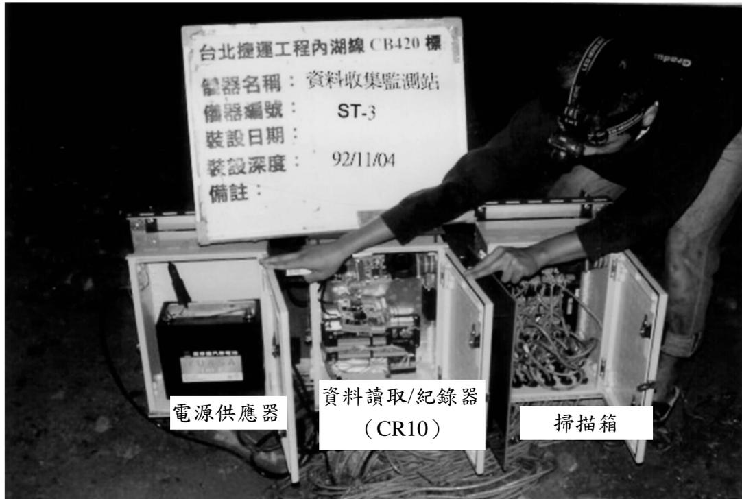
圖 7-20 自動監測系統資料收集監測站 ST3 (主跑道南側草坪上)
