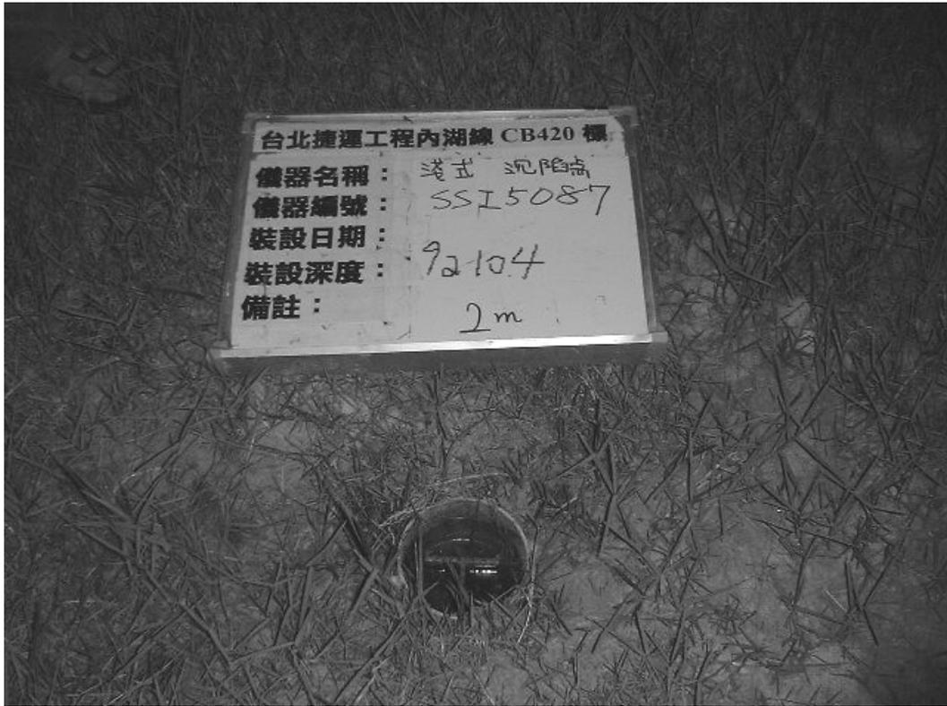
圖 7-18 機場內部淺式沉陷觀測點 (SSI)
