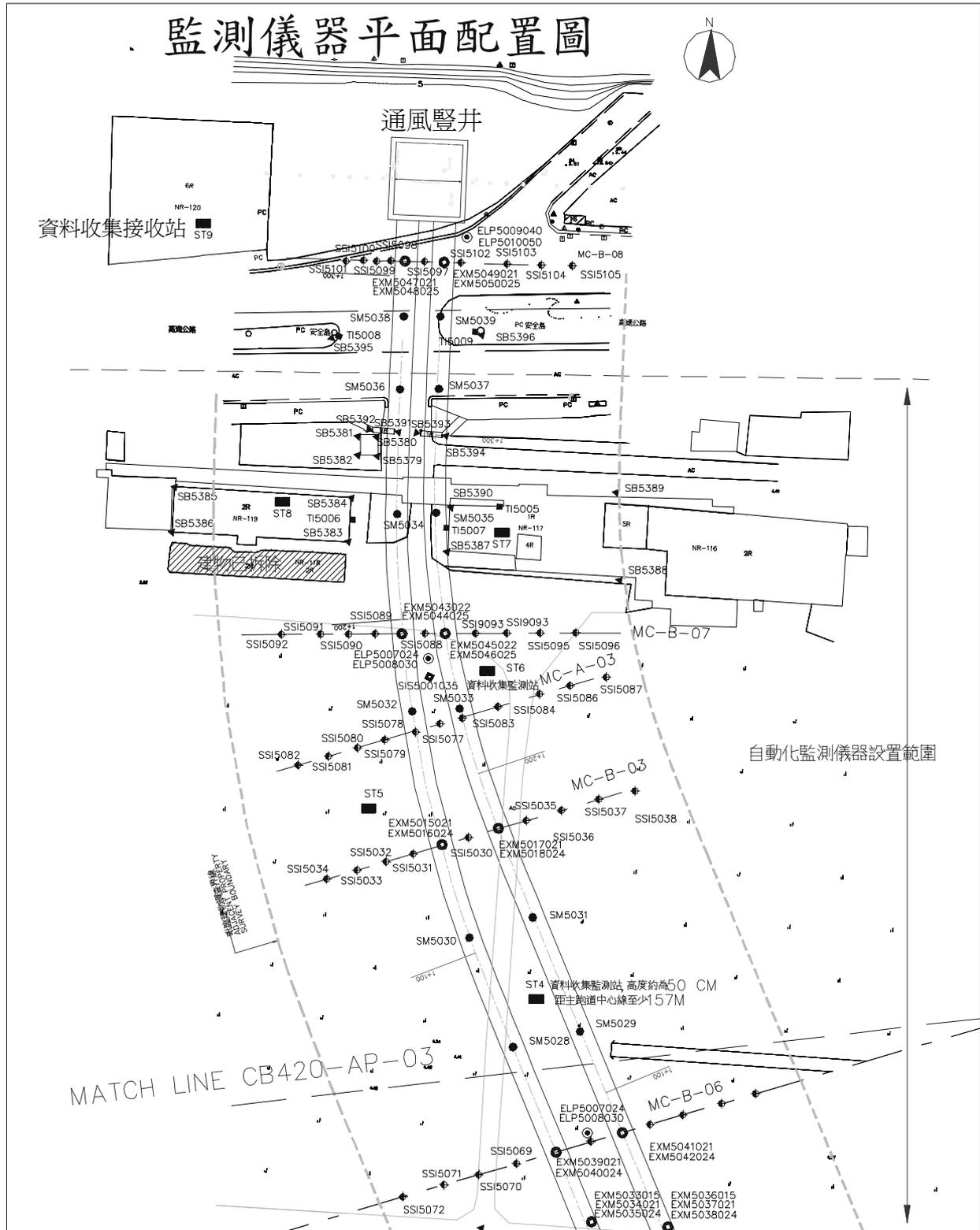
圖 7-14 (a) 監測儀器平面配置圖
