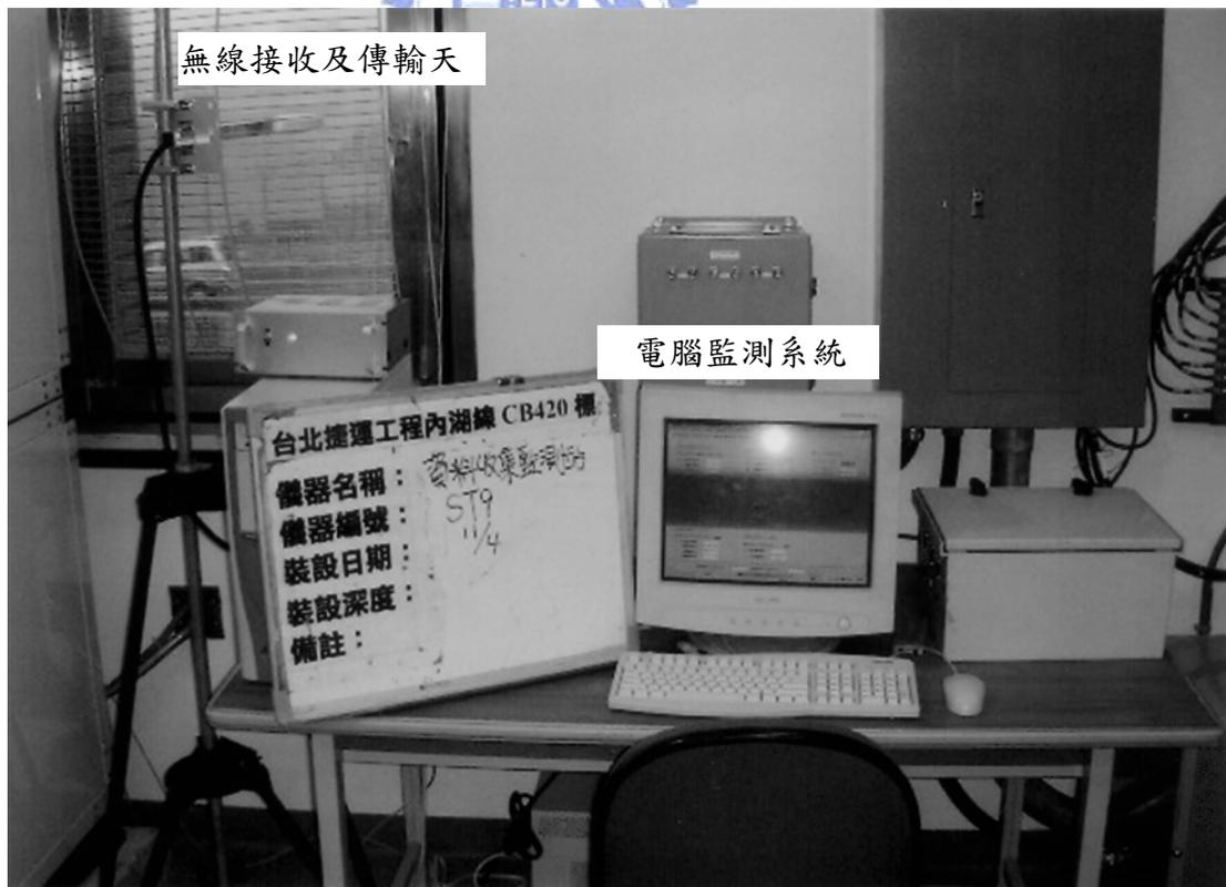
圖 7-21 自動監測系統資料收集接收站 ST9 (濱江街雷達台 5F)
