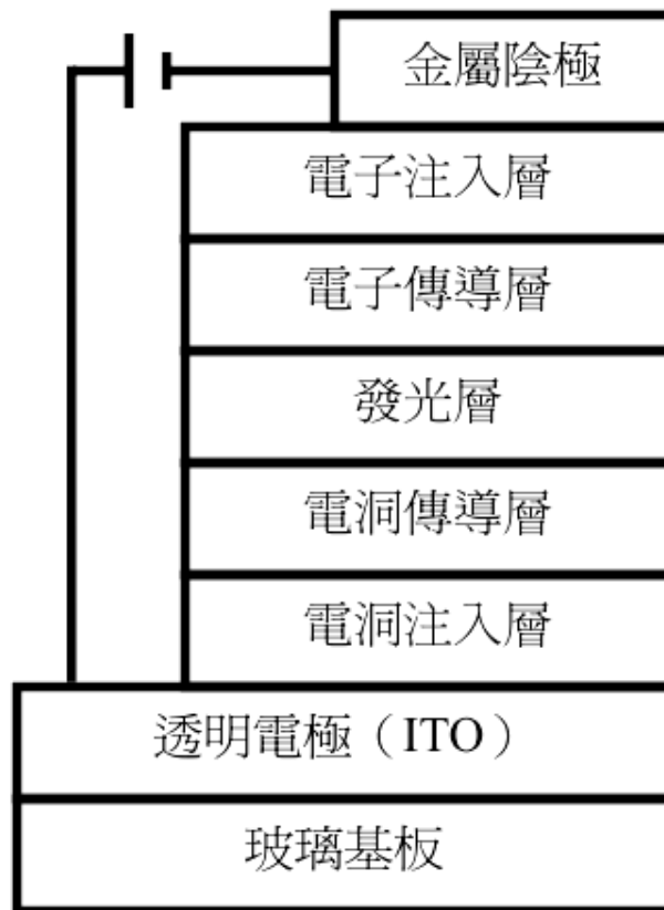
圖 1 有機發光二極體 OLED 多層結構
