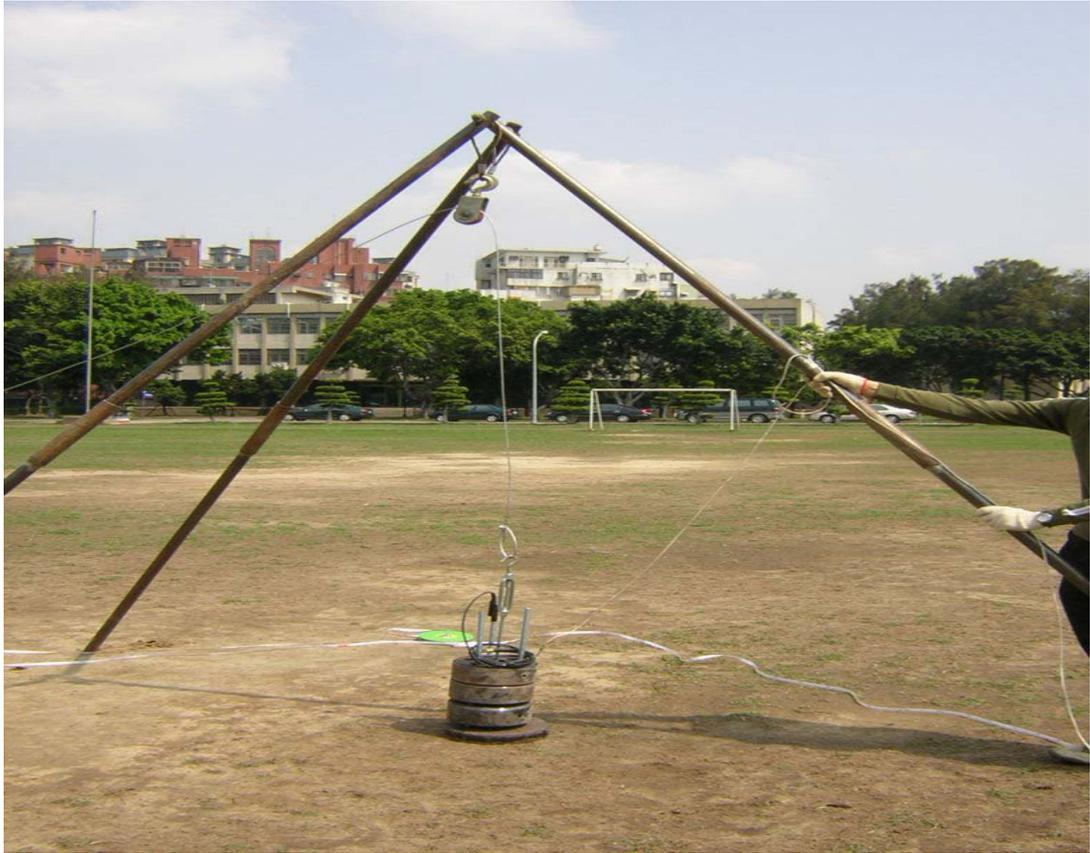
圖 3.1.7 自由落錘(weight drop)
