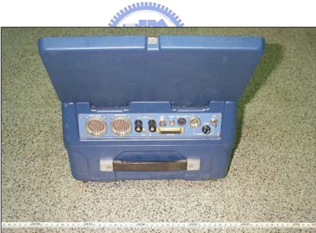
圖 3.1.2 多波道可攜帶式數位震測儀(背面)
