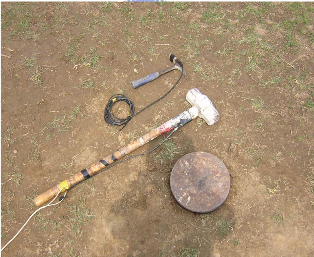
圖 3.1.6 長柄手持式鐵鎚、地質鎚及鐵板
