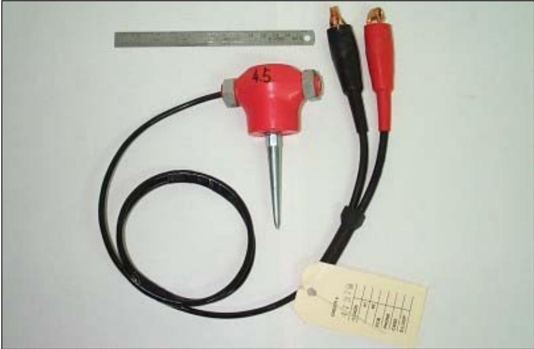
圖 3.1.5 高感度電磁式速度受波器
