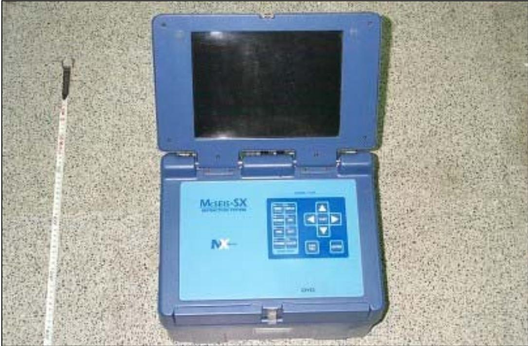
圖 3.1.1 多波道可攜帶式數位震測儀(正面)
