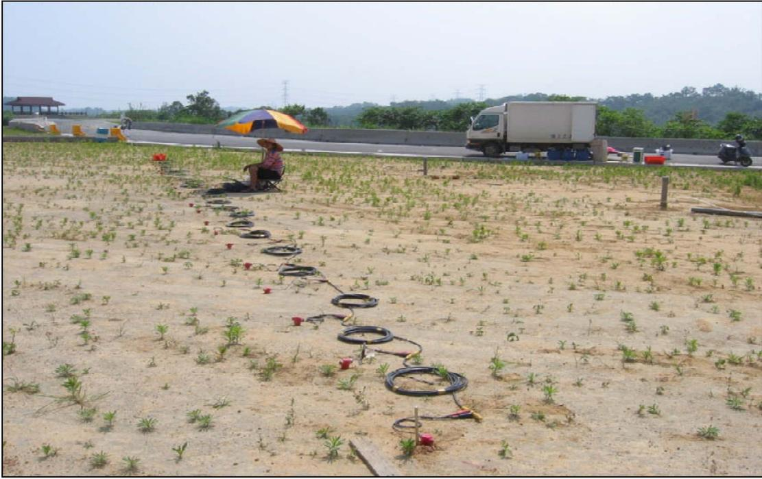
圖 3.2.5 表面波震測試驗(新竹寶二水庫)
