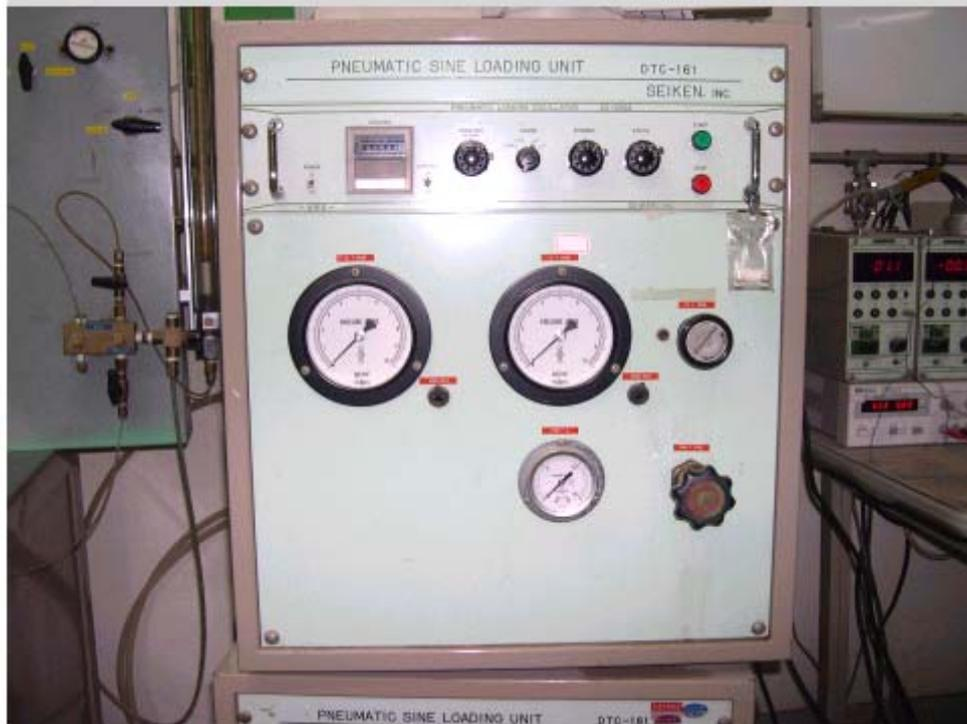
圖 3-3 動態三軸試驗之氣壓式正弦波產生器
