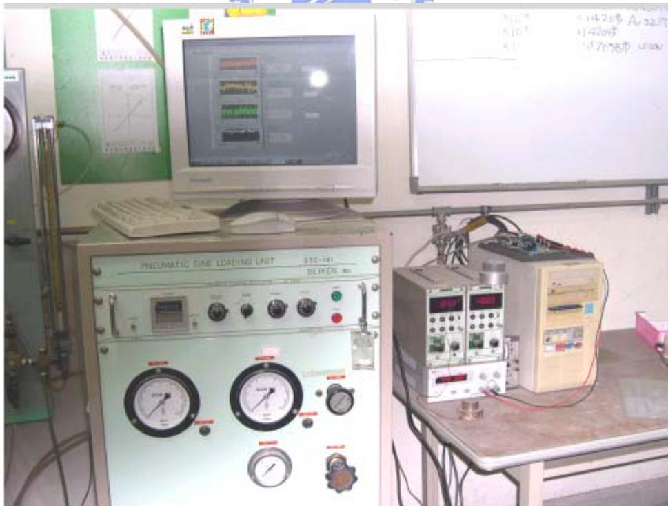
圖 3-2 動態三軸試驗之擷取系統
