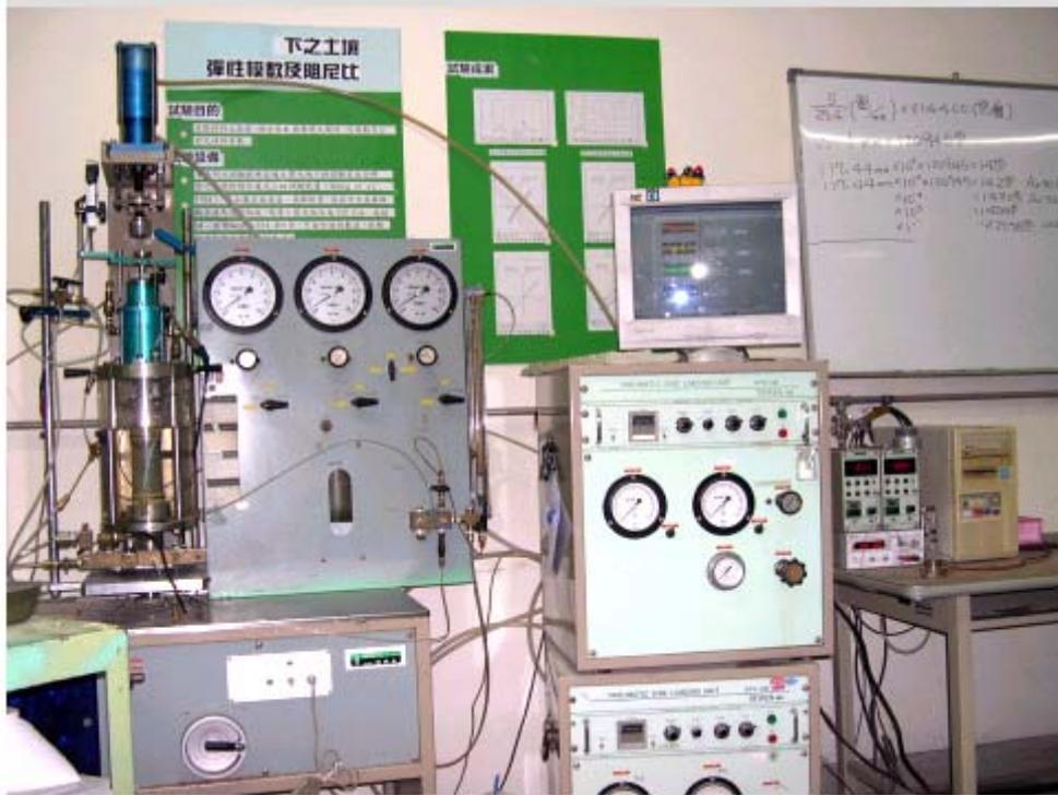
圖 3-1 動態三軸試驗儀外觀
