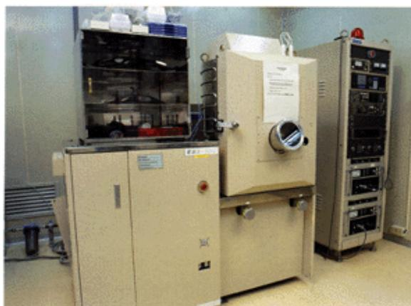
圖 3-4 雙電子槍蒸鍍系統外觀圖
