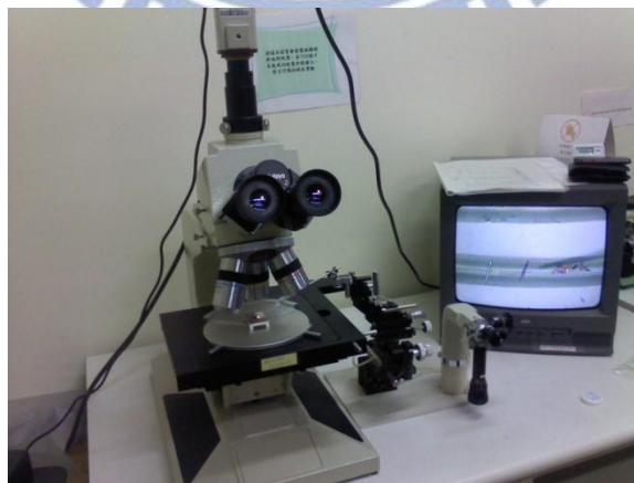
圖 4.3.2.3 三軸探針座調動微米捲管位置的示意圖
