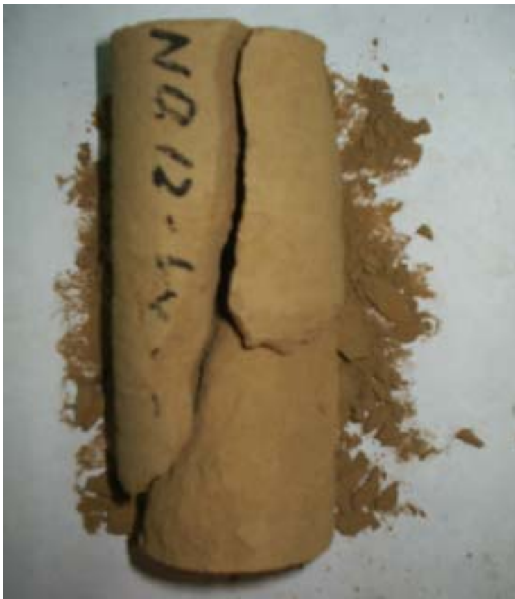
NO.5 破壞情形
