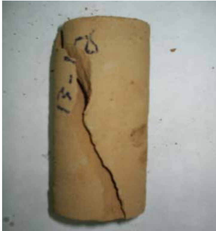
NO.2 破壞情形
