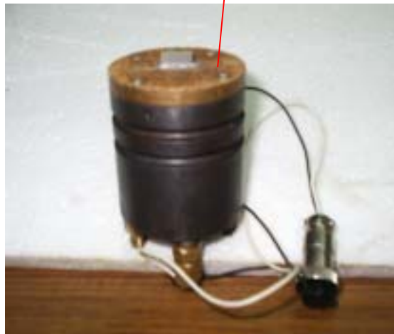
圖 3-15 上下蓋加裝剪力波元件完成圖
