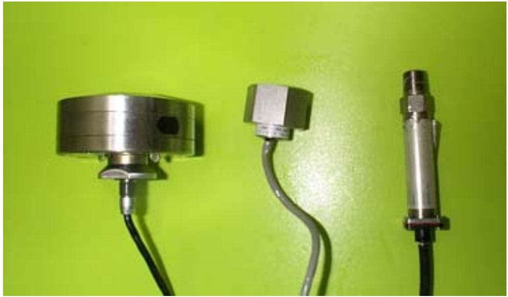
圖 3-8 內置式荷重計、壓力轉換器
