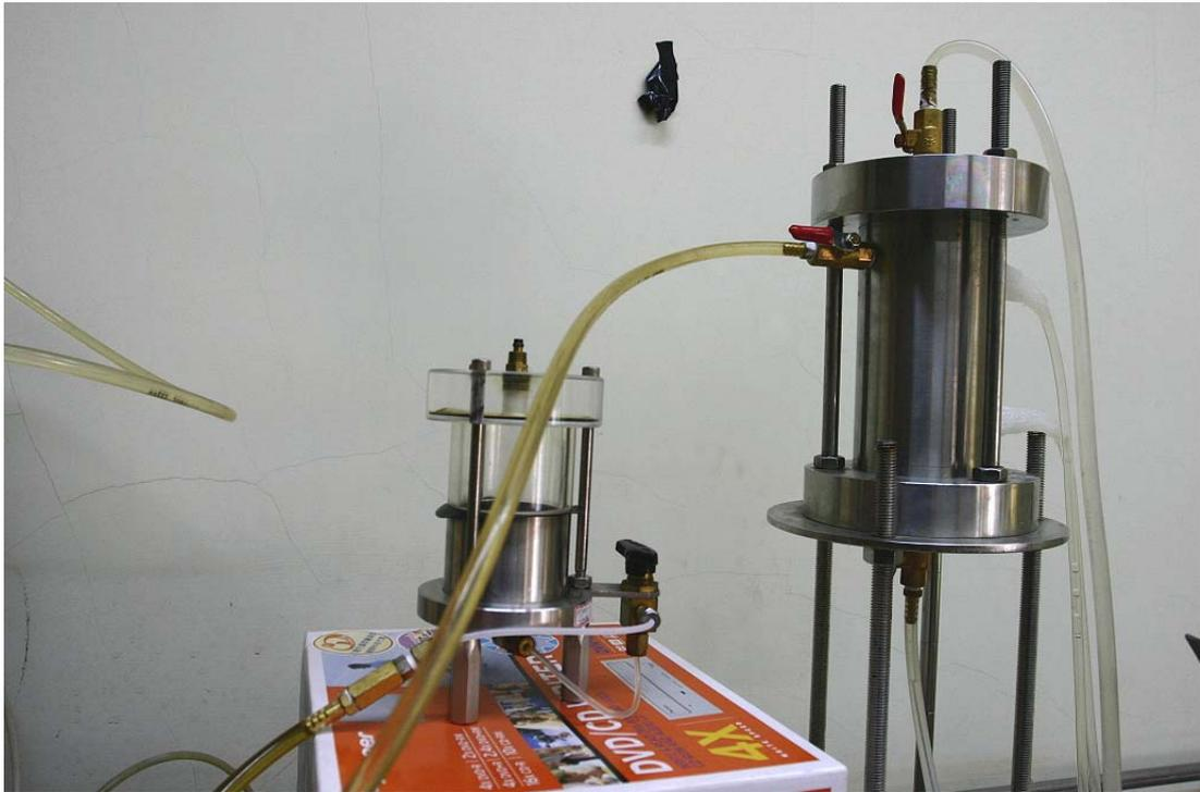
圖 3.11 PID 連接滲透儀主體部分
