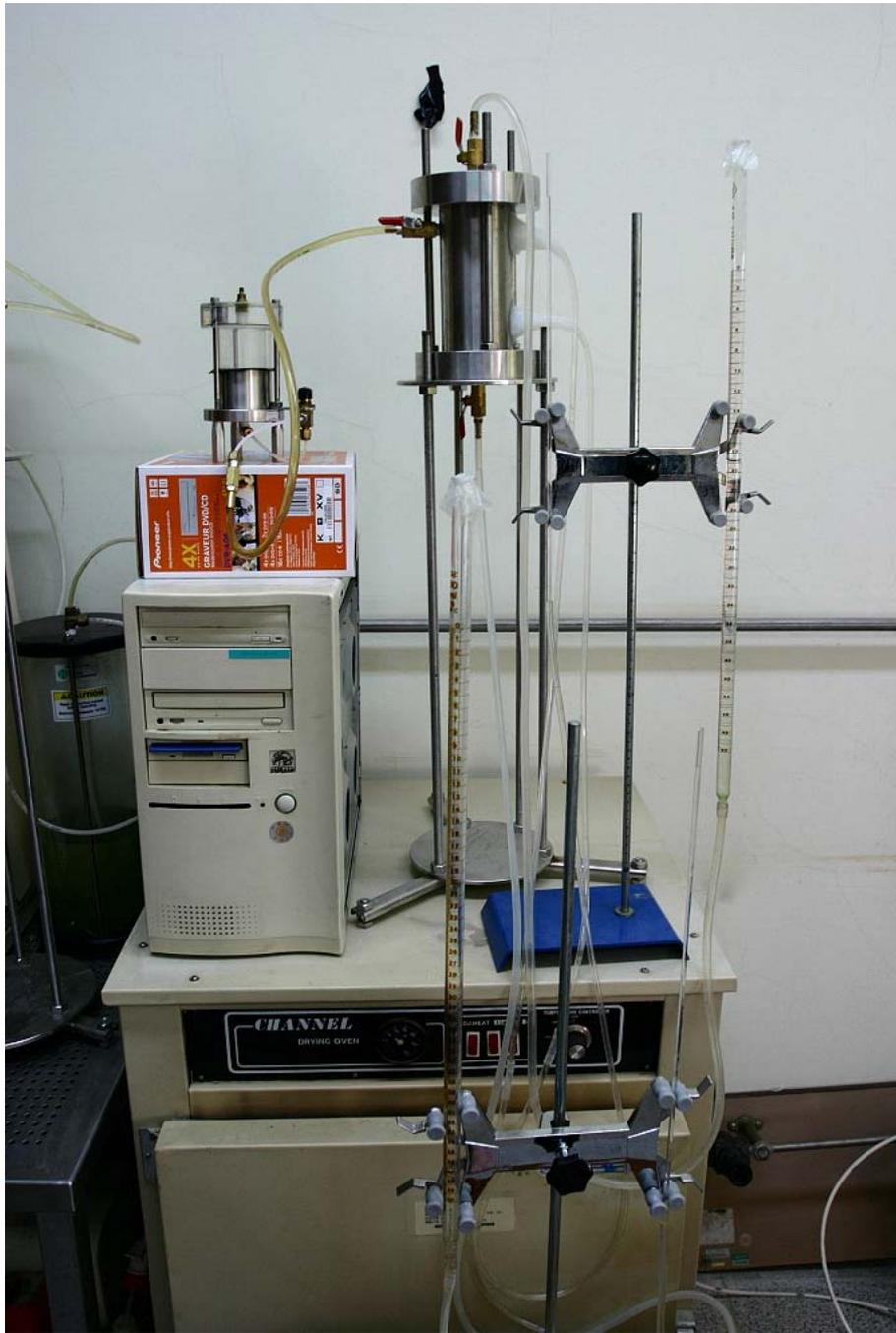
圖 3.12 滲透儀試驗裝置
